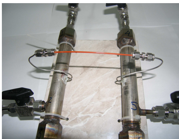
Σχήμα 4: οι δεξαμενές του αερίου
