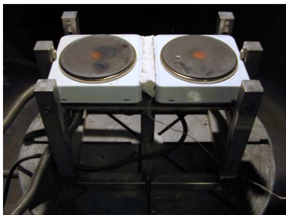
Σχήμα 43α: Θερμαντικά στοιχεία της διάταξης συλλογής σταγονιδίων
