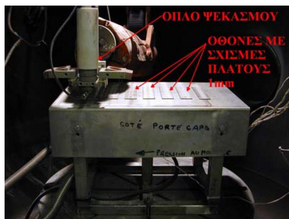
Σχήμα 43δ: Διάταξη συλλογής μικρού αριθμού σταγονιδίων και όπλο ψεκασμού
