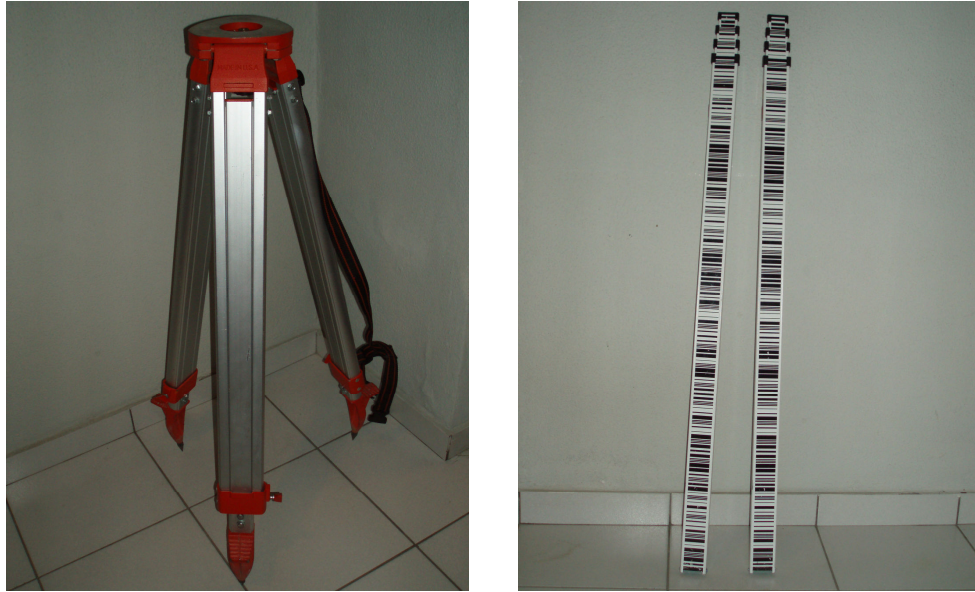
Εικόνα 4.4. Ο τρίποδας αλουμινίου και οι δύο τηλεπισκοπικές σταδίες Figure 4.4. The aluminium tripod and the telescopic leveling rods
