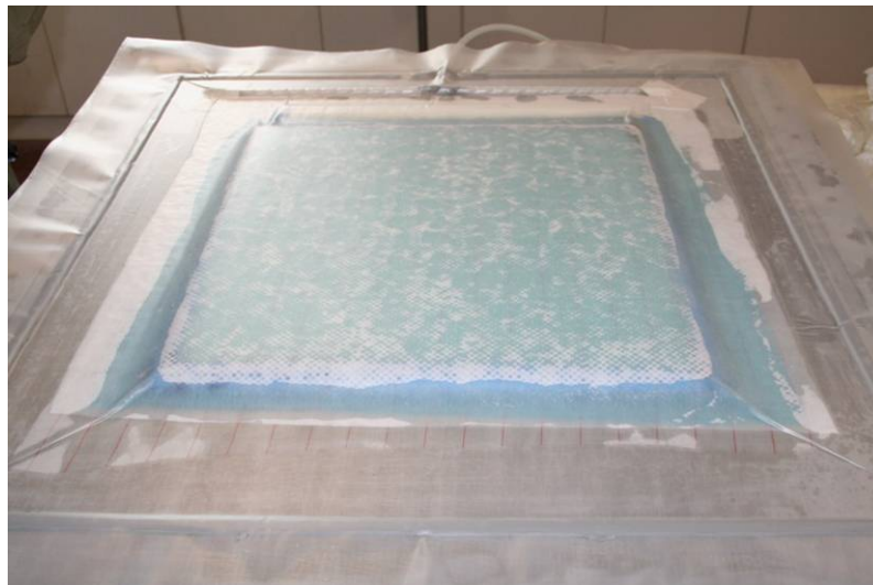
Σχήμα 5.9: Πολύστρωτο υπό συνθήκες πίεσης κενού (vacuum bag moulding).
