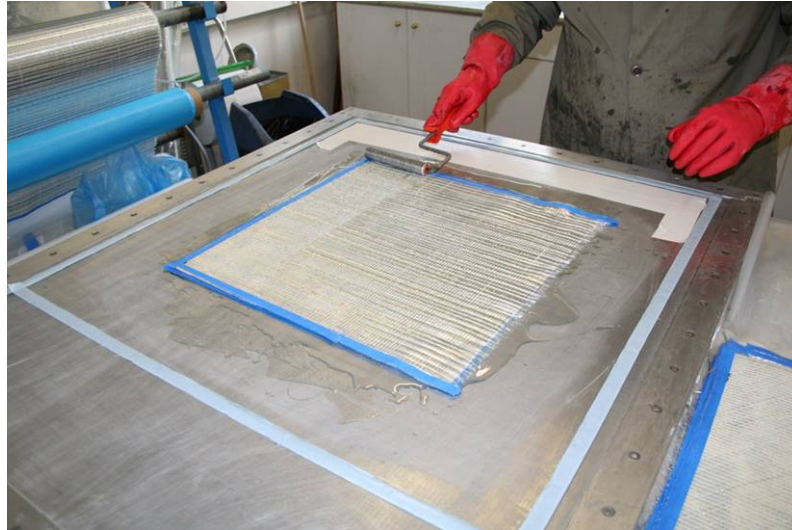
Σχήμα 5.8: Κατασκευή πολύστρωτου με τη μέθοδο “επίστρωσης με το χέρι” (hand lay up).
