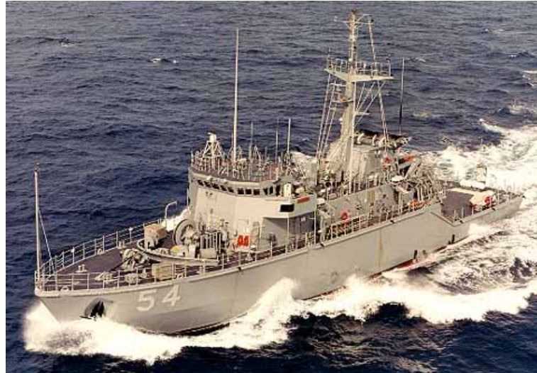
Σχήμα 1.2: Σκάφος ναρκοπολέμου του Αμερικανικού Πολεμικού Ναυτικού, κλάσης Osprey, κατασκευασμένο από GRP.
