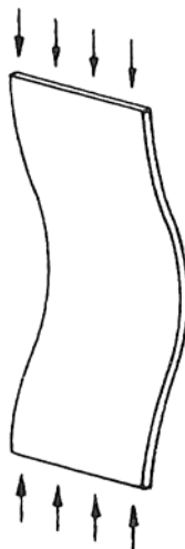
Σχήμα 1.3: Σχηματική αναπαράσταση του φαινομένου του λυγισμού σε αμφίπακτη δοκό.
