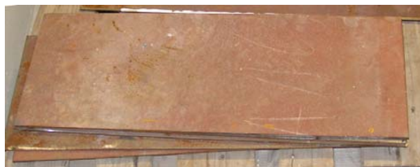
Εικόνα 3.1: Φύλλα ναυπηγικού χάλυβα ΑΗ36
