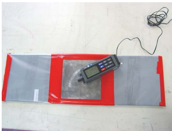
Σχήμα 2.2.3: Καλυμμένο δοκίμιο, έτοιμο για τη δοκιμή επιταχυνόμενης διάβρωσης.
