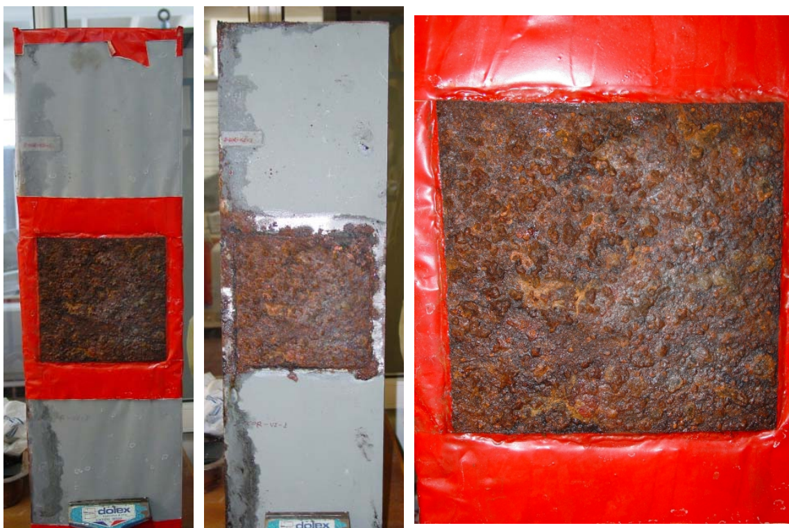
Σχήμα 2.2.6: Δοκίμιο S-COR-VI-1 μετά την απομάκρυνση από το θάλαμο ψεκασμού άλατος.
