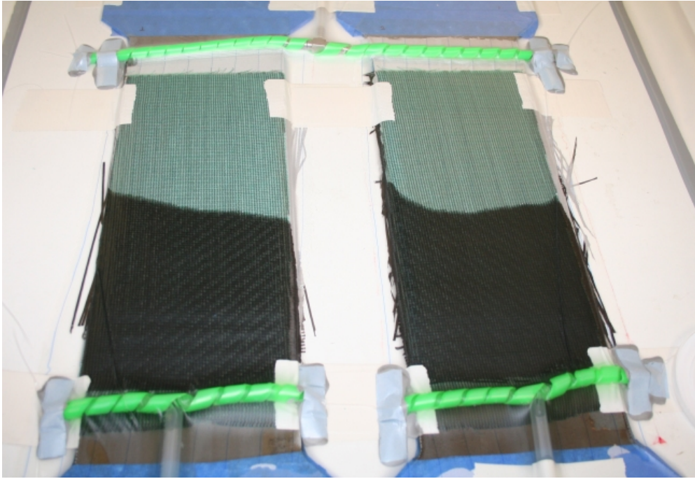
Σχήμα 2.2.7: Έγχυση ρητίνης υπό συνθήκες κενού για τα δοκίμια S-COR-VI1&2
