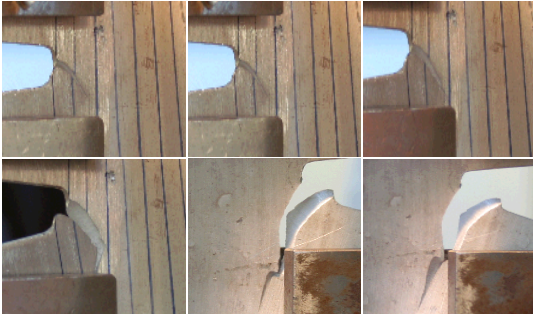
Εικόνα 4-45: Στάδια διάδοσης της ρωγμής του δοκιμίου CTg1RP: (α) έναρξη ρωγμής διαγώνια προς τα κάτω με μεγάλη κλίση, (β) συνέχιση διάδοσης ρωγμής προς τα κάτω, (γ) καθυστέρηση ρωγμής μεταξύ ευθειών 1-2, (δ) αναστροφή ρωγμής και διάδοση προς την αντίθετη κατεύθυνση, (ε) συνέχιση διάδοσης ρωγμής προς τα κάτω (πρόσθια όψη δοκιμίου), (στ) διάδοση ρωγμής υπό κλίση ως προς την ενίσχυση με πριν και ολοκλήρωση πειράματος.
