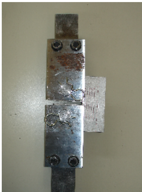
Εικόνα A-2: Απεικόνιση των εξαρτημάτων συγκράτησης, των πύρων συγκράτησης και των δακτυλίων που χρησιμοποιήθηκαν για τη συγκράτηση των δοκιμίων CT στη μηχανή εφελκυσμού
