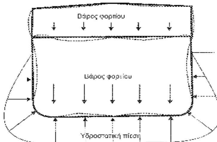
Σχήμα 3-1: Στατικές φορτίσεις στην εγκάρσια τομή του πλοίου
