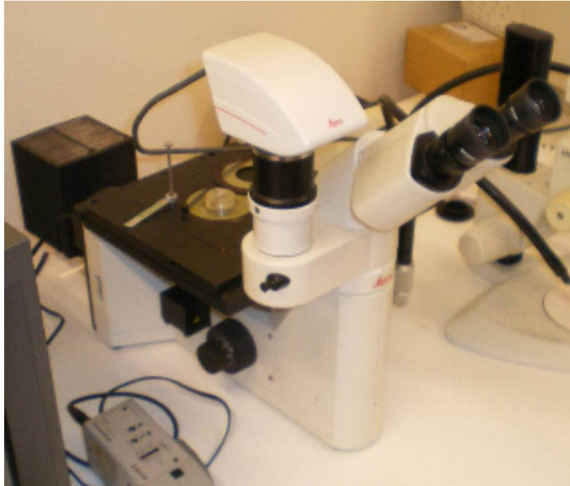
Εικόνα Α-6: Οπτικό μικροσκόπιο με δυνατότητα μεγέθυνσης έως x1000. Χρησιμοποιήθηκε για την μεταλλογραφιών παρατήρηση των δειγμάτων
