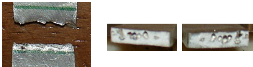
Εικόνα 4-24: Τρόπος θραύσης δοκιμίου 2Dx (δεξιά), ύπαρξη πορώδους στην περιοχή της θραύσης, λόγω της συγκόλλησης (αριστερά)
