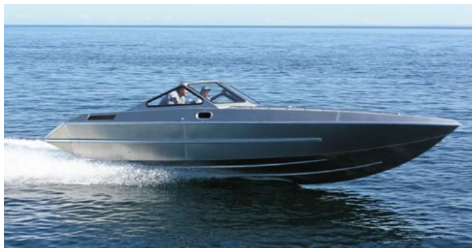
Εικόνα 2-3: Ταχύπλοο σκάφος κατασκευασμένο από κράματα αλουμινίου
