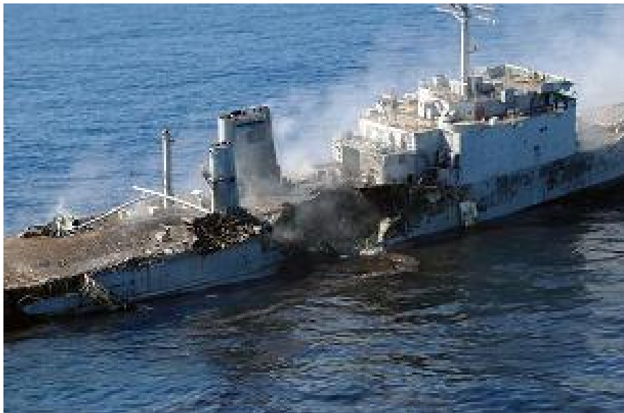
Εικόνα 3-1: Θραύση και κοπή στα δύο δεξαμενόπλοιου Schenectady
