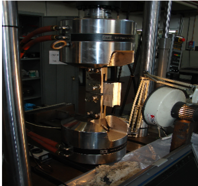
Εικόνα 4-2: Η διάταξη της μηχανής εφελκυσμού MTS με την οποία πραγματοποιήθηκαν τα πειράματα
