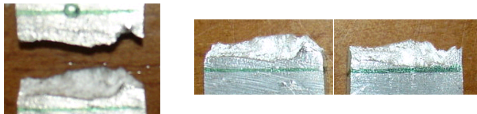
Εικόνα 4-25: Τρόπος θραύσης δοκιμίου 4Dx (δεξιά), ανώμαλη επιφάνεια θραύσης δοκιμίου 4Dx (αριστερά)
