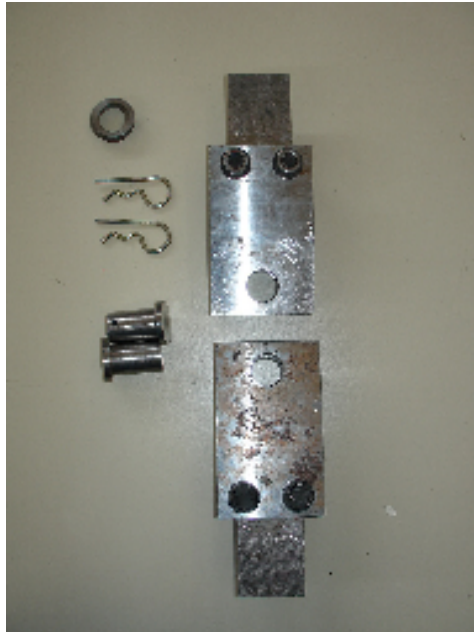
Εικόνα A-2: Απεικόνιση των εξαρτημάτων συγκράτησης, των πύρων συγκράτησης και των δακτυλίων που χρησιμοποιήθηκαν για τη συγκράτηση των δοκιμίων CT στη μηχανή εφελκυσμού
