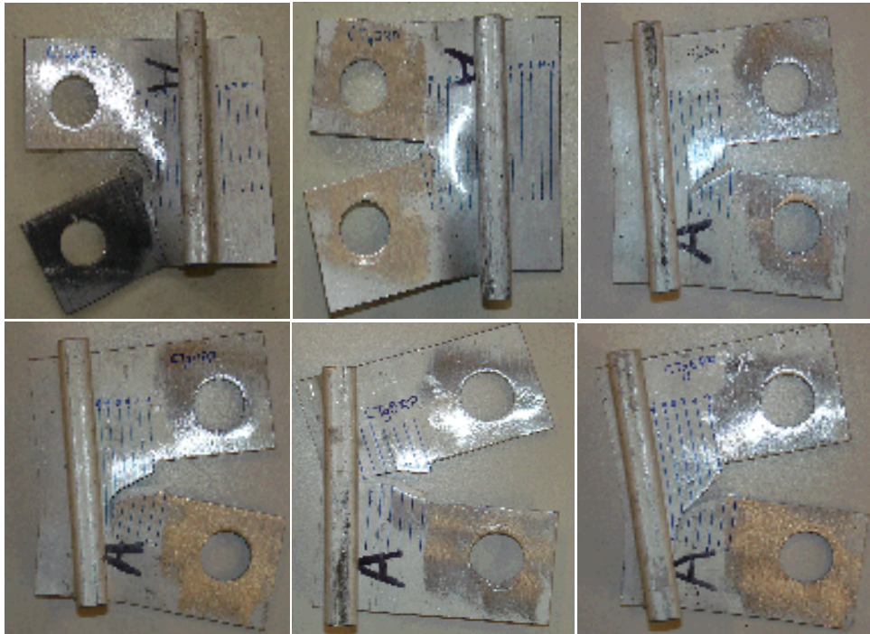
Εικόνα 4-51: Τελική μορφή δοκιμίων CT με ενίσχυση βολβολάμας με “rear plate” μετά την ολοκλήρωση των πειραμάτων, με τη σειρά που αναλύθηκαν παραπάνω
