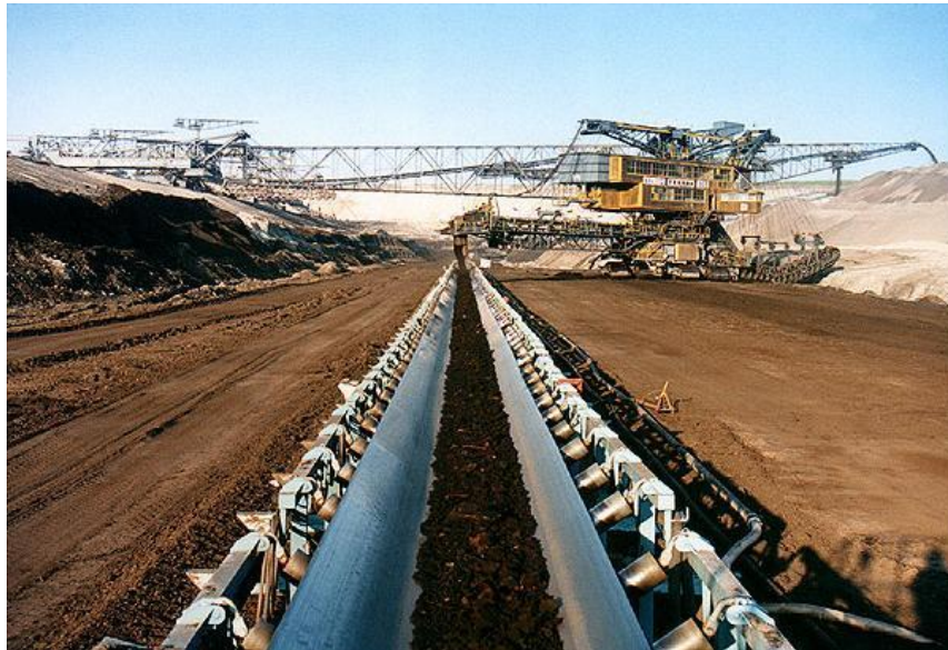
Εικόνα 3.4.7. Μεταφορά λιγνίτη με ταινιόδρομους, [6]
