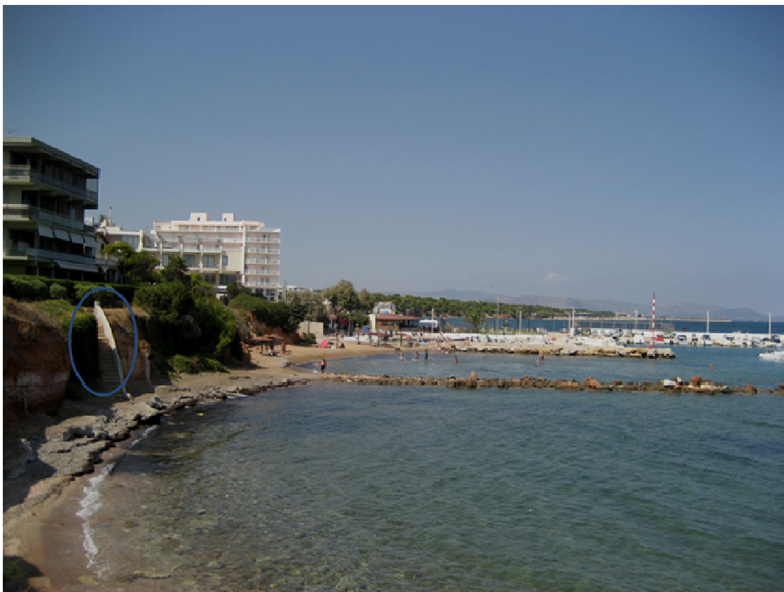
Φωτογραφία 49. Παραλιακές ιδιοκτησίες που πλησιάζουν την ακτογραμμή στο Μάτι. Η παραλία έχει υποστεί σημαντική διάβρωση από την επέκταση της μαρίνας( τα σκαλοπάτια που φαίνονται έχουν σχεδόν γκρεμιστεί). Στο βάθος διακρίνονται τα δύο ξενοδοχεία.
