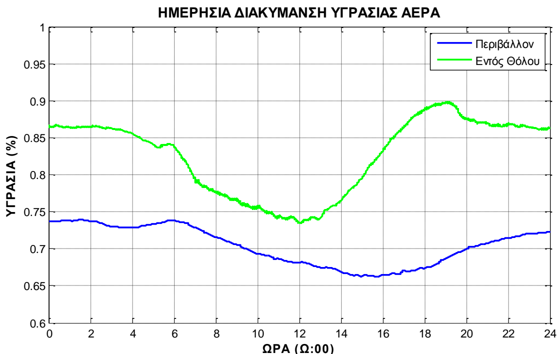
Εικόνα 5.3.1-3 – Μέση τιμή της ημερήσιας διακύμανσης της σχετικής υγρασίας του αέρα περιβάλλοντος και του αέρα εντός του θόλου.
