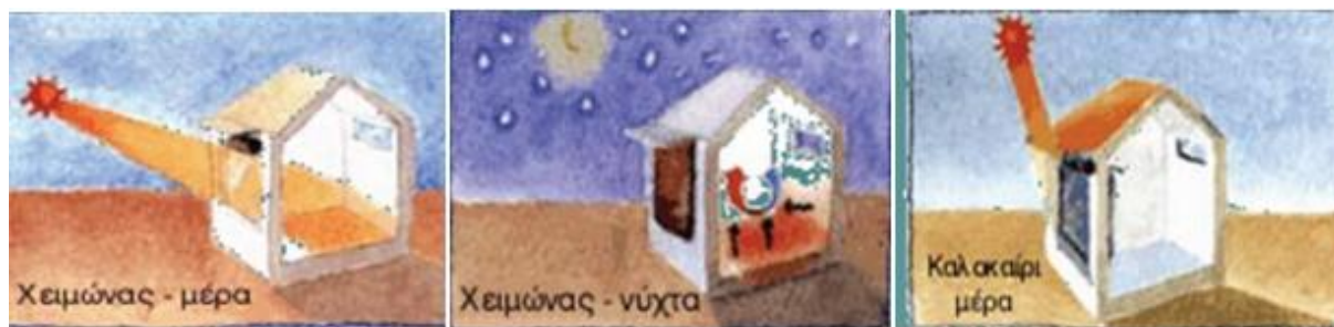
Εικόνα 1.3-1: Τρεις βασικές αρχές του βιοκλιματισμού: απρόσκοπτη είσοδος της ηλιακής ακτινοβολίας εντός του κτιρίου κατά τη διάρκεια της χειμερινής ημέρας και διατήρηση της θερμότητας αυτής το βράδυ, και επαρκής προστασία από τις ηλιακές ακτίνες το καλοκαίρι. 8
