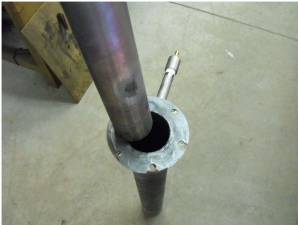
Εικόνα Α.19. Μετά την φόρτωση των προς αναγωγή pellets, ξανασυναρμολογείται το σύστημα του κυλίνδρου αναγωγής.
