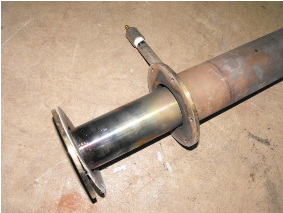
Εικόνα Α.13. Οι δύο κύλινδροι που συνθέτουν το σύστημα ανάρτησης του δειγματοφορέα.
