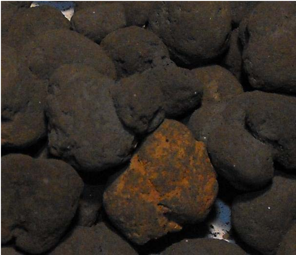
Εικόνα 7.5. Φρύγμα καταλοίπων βωξίτη δοκιμής 17 (T 970°C, CO/CO 2 80/20)
