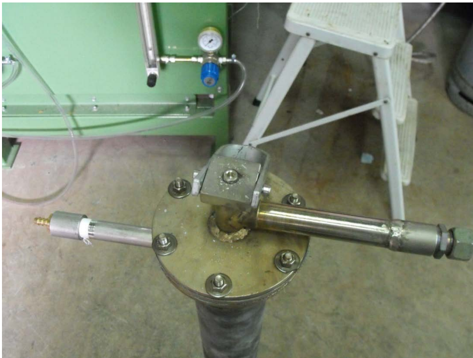
Εικόνα Α.12. Ο κύλινδρος που περιέχει τον δειγματοφορέα που γίνεται η αναγωγή, εκτός του καμινιού.
