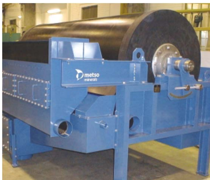
Εικόνα 8.2. Φωτογραφία ενός υγρού μαγνητικού διαχωριστή χαμηλής έντασης σειρά WS 1200 και διατίθεται σε τέσσερις τύπους ανάλογα με την ροή της τροφοδοσίας και την φορά κίνησης του μαγνητικού τυμπάνου.
