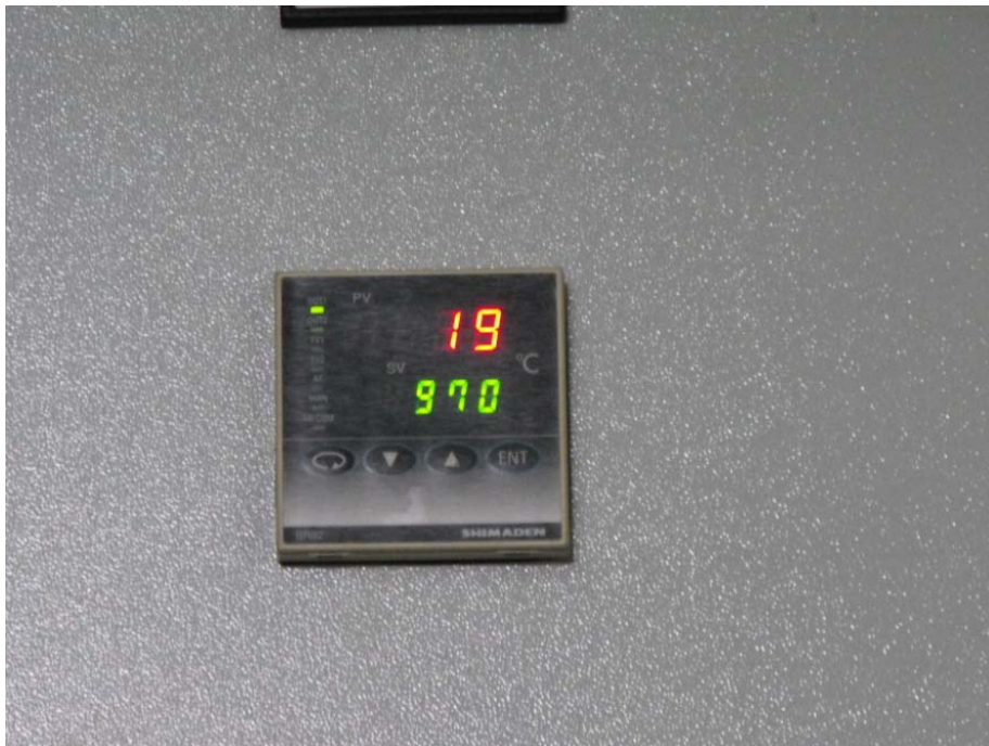
Εικόνα Α.5. Ρύθμιση και ένδειξη από πυρόμετρο της θερμοκρασίας. Η κόκκινη ένδειξη είναι η πραγματική και η δεύτερη πράσινη η ρυθμιζόμενη τελική.
