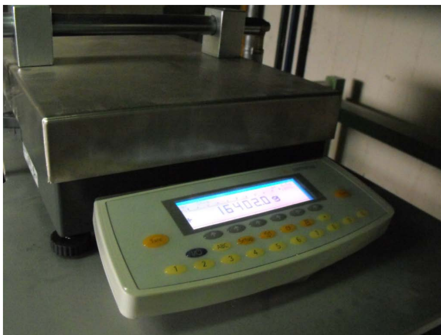
Εικόνα Α.10. Η ζυγαριά ακριβείας SARTORIUS. Χρειάζεται μισή ώρα ενεργοποίηση πριν τα πειράματα για να έχει ακρίβεια στις μετρήσεις. Για το συγκεκριμένο βάρος η ακρίβεια είναι 0,5 g.
