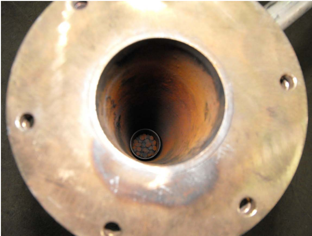
Εικόνα Α.15. Εντός του εσωτερικού κυλίνδρου διακρίνουμε το «κύπελλο» του δειγματοφορέα το οποίος περιέχει τα pellets.
