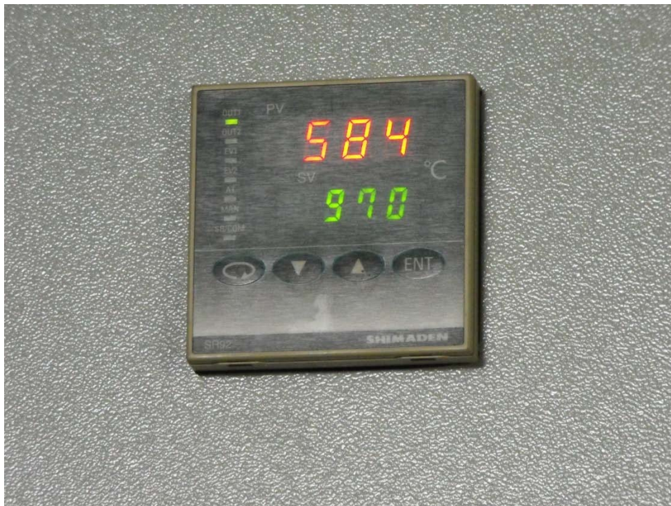
Εικόνα Α.22. Η αύξηση της θερμοκρασίας μέχρι την επίτευξη της τελικής κατά το στάδιο της προθέρμανσης.
