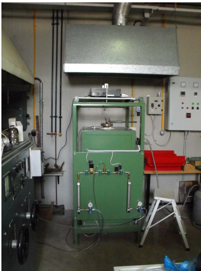
Εικόνα Α.2. Το καμίνι αναγωγικής φρύξης. Η θέρμανση προκαλείται από ηλεκτρική αντίσταση.
