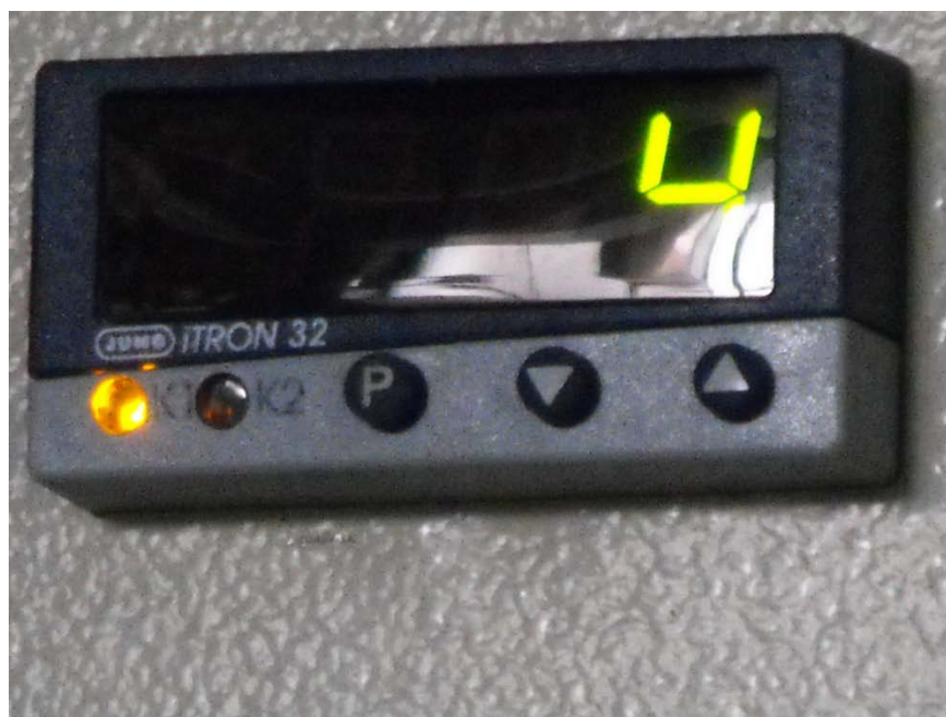
Εικόνα Α.9. Η ένδειξη των ppm CO στον αέρα γύρω από το καμίνι. Πατώντας το κουμπί P και με τα βέλη άνω και κάτω μπορούμε να ρυθμίσουμε το όριο ενεργοποίησης του συναγερμού (πχ 100ppm).
