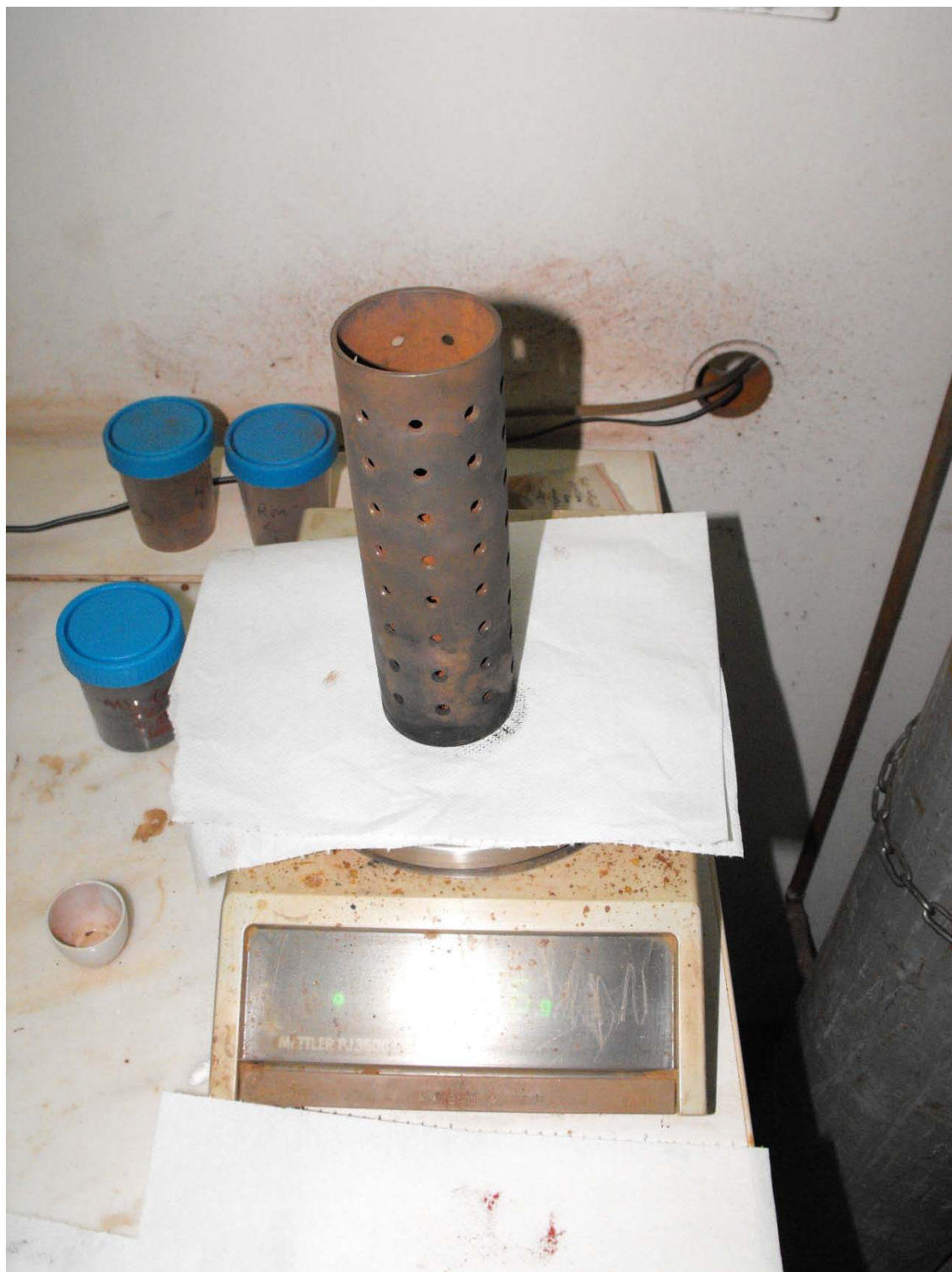
Εικόνα Α.17. Το κύπελλο που περιέχει το δείγμα των pellets. Οι οπές του υπάρχουν και στη βάση του και σκοπός τους είναι η ελεύθερη διέλευση των αερίων μιγμάτων της αναγωγής ή του αζώτου όταν γίνεται η πύρωση.
