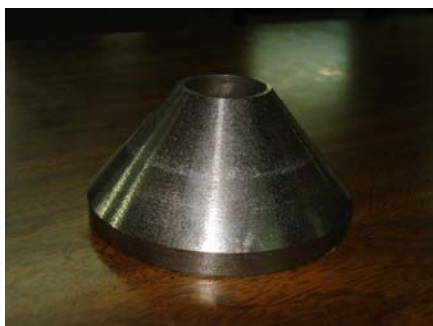
Σχ. 3.2.4 Κωνική μήτρα-εργαλείο ημιγωνίας κορυφής \alpha = 40^\circ
