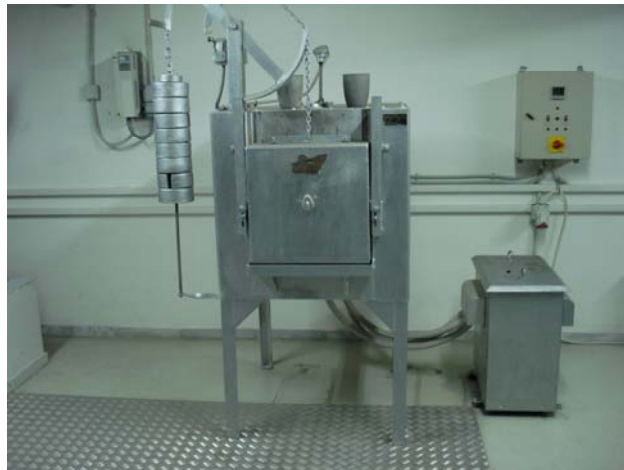
Σχ. 3.3.3 Φούρνος OSMUNND 9,5 KW στον οποίο έγινε η θερμική επεξεργασία των δοκιμίων
