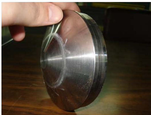
Σχ. 3.2.3 Κωνική μήτρα-εργαλείο ημιγωνίας κορυφής \alpha = 65^\circ
