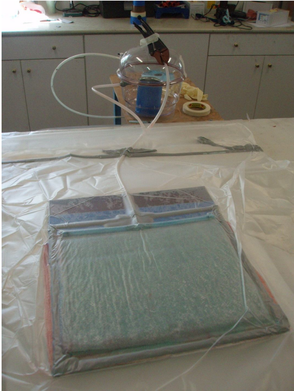
Σχήμα 3.18: Μορφοποίηση με σάκο κενού του δεύτερου τμήματος του πολύστρωτου
