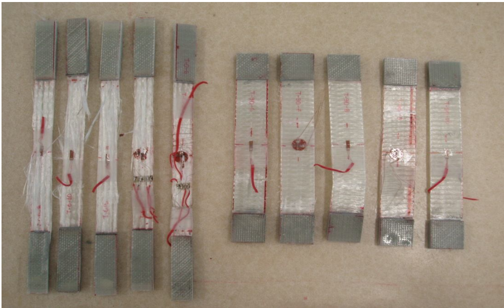
Σχήμα 3.7: Φωτογραφία δοκιμίων μετά τα πειράματα (T-0 αριστερά , T-90 δεξιά)
