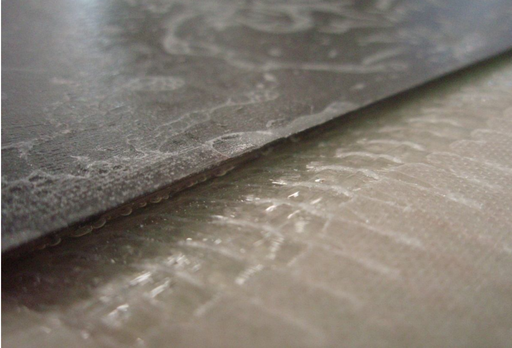
Σχήμα 3.17: Κενό μεταξύ πολυστρωτου και χάλυβα
