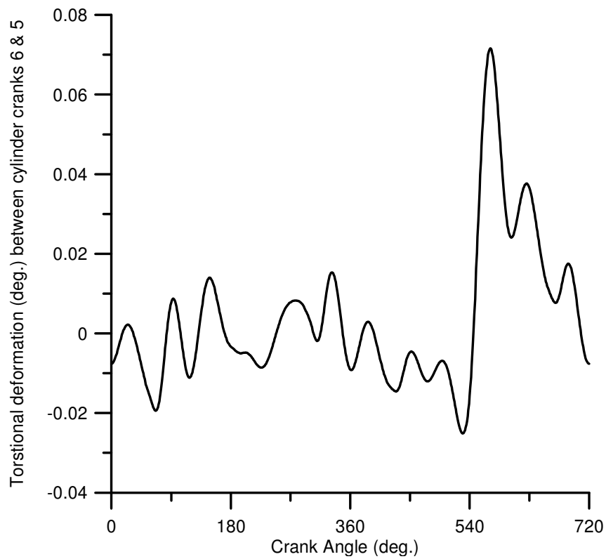
Σχήμα 4.23. Στρεπτικές παραμορφώσεις ανάμεσα στα στρόφαλα 6 και 5 κατά την διάρκεια ενός κύκλου λειτουργίας.
