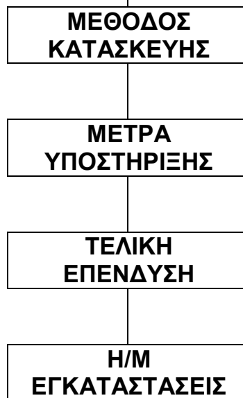
Σχήμα 15 – Μέρη κατασκευής σήραγγας
