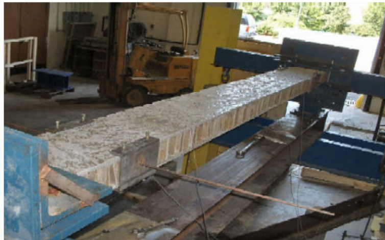
Σχήμα 12. Δοκιμή στρέψης σε HFRP σάντουιτς δοκό
