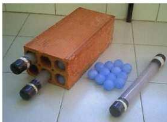
Σχήμα 2.13 Τούβλο ενισχυμένο με PCM
