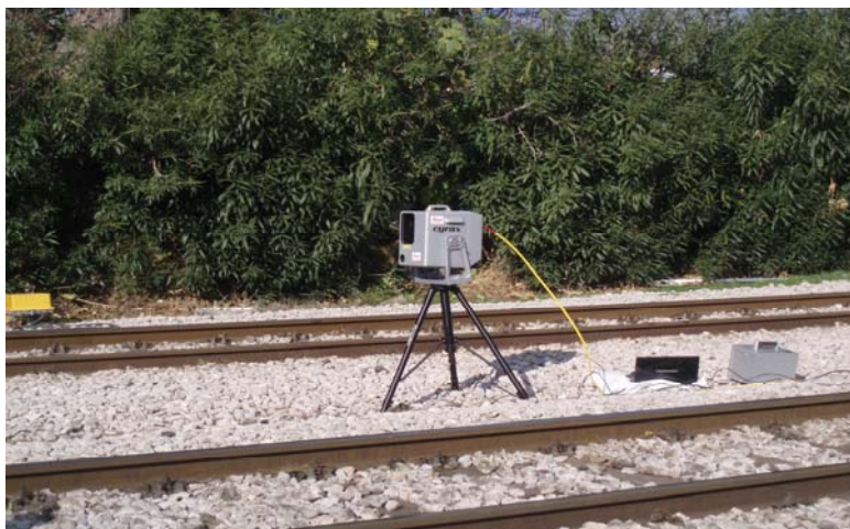
Εικόνα 3.3: Επίγειος σαρωτής Cyrax 2500 με τα βασικά μέρη του συστήματος
