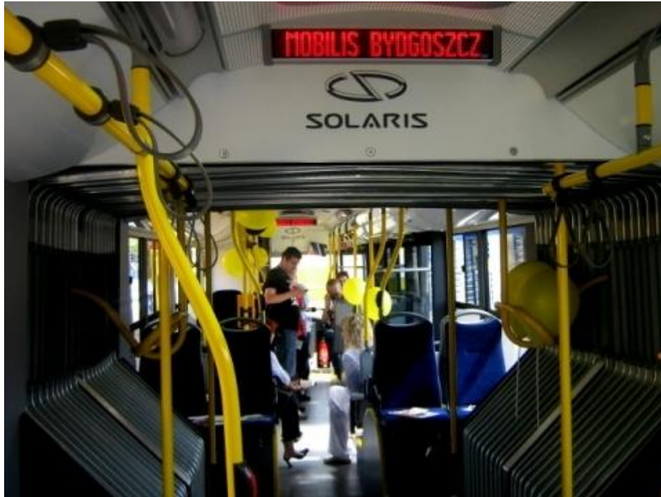
Σχήμα 29 : Ορθοστάτες στο ενδιάμεσο τμήμα του αρθρωτού λεωφορείου
