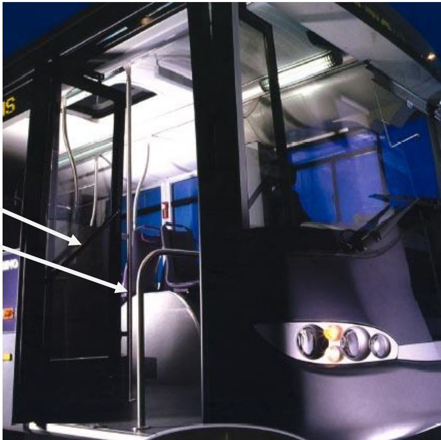
Σχήμα 26 : Χειρολαβές ενδιάμεσα και εκατέρωθεν του ανοίγματος των θυρών
