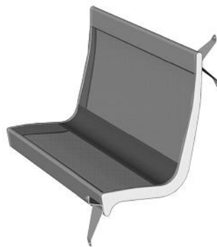
Σχήμα 14 : Απεικονίζεται το εσωτερικό τμήμα ενός καθίσματος λεωφορείου κάτω δηλαδή από την επένδυση της ταπετσαρίας.
