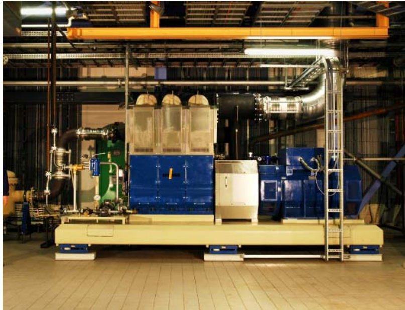
Εικόνα 5.2 : Ατμομηχανή σε μονάδα συμπαγωγής ισχύος 500 kWel
