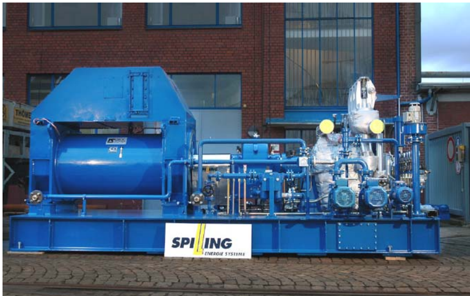
Εικόνα 5.1 : Ατμοστρόβιλος 500 kW της εταιρίας Spilling
