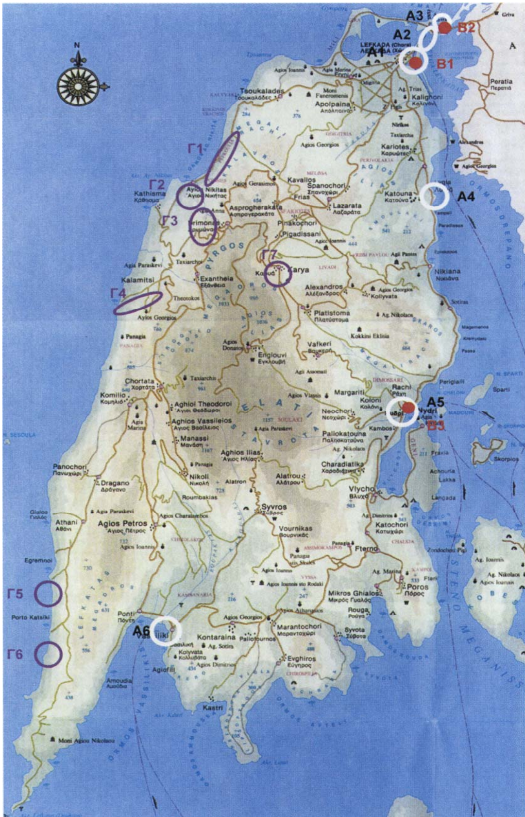
Χάρτης 3.3: Θέσεις βλαβών γεωτεχνικού χαρακτήρα. Οι μωβ κύκλοι δείχνουν τις αστοχίες φυσικών πρηνών, ορυγμάτων και επιχωμάτων οδοποιίας κυρίως βραχώδους αλλά και εδαφικής σύστασης.
