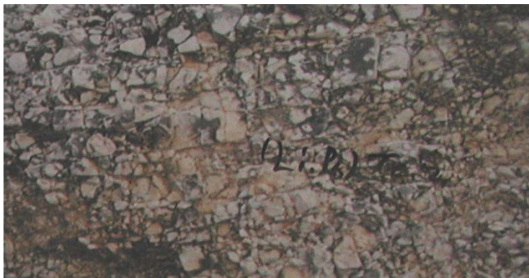
Εικόνα 5.2: Εντονότατα κατακερματισμένοι ασβεστόλιθοι του Παντοκράτορα με λείες ομορρόπες διεπιφάνειες τοπικά.
