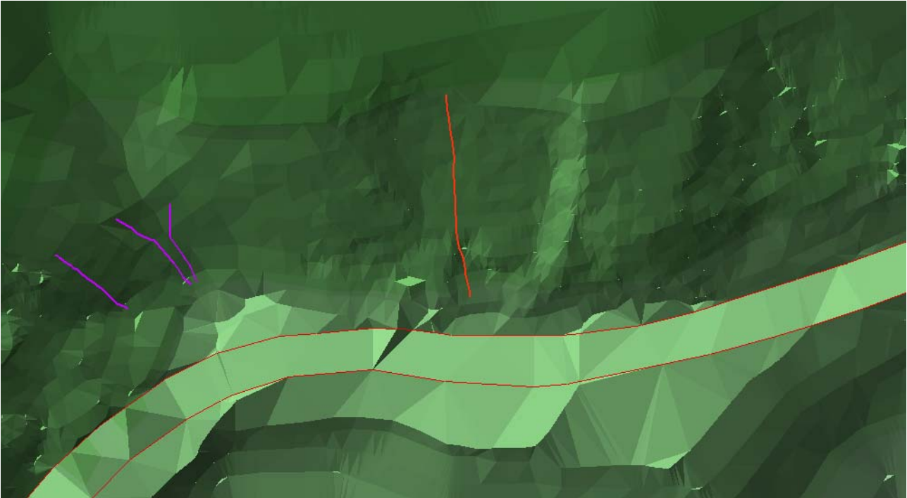
Εικόνα 5.18: Καταπτώσεις στο τμήμα Β ( Χ.Θ. 0+800 έως Χ.Θ. 1+700). Διατομές 50 έως και 51.
