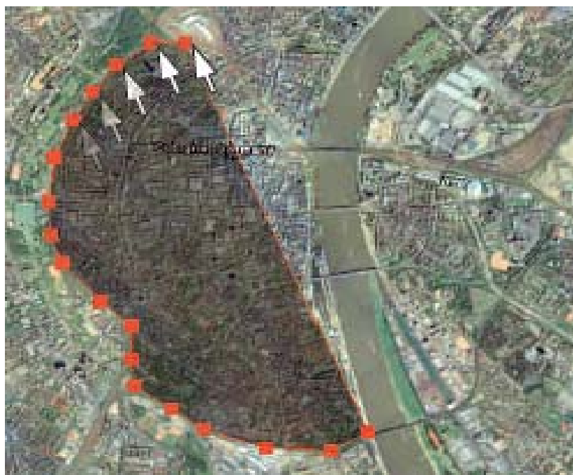
Σχήμα 2.2: Οι κορυφές του ορίου στην προβολή του ορθοφωτοχάρτη του λογισμικού της IGiplan
