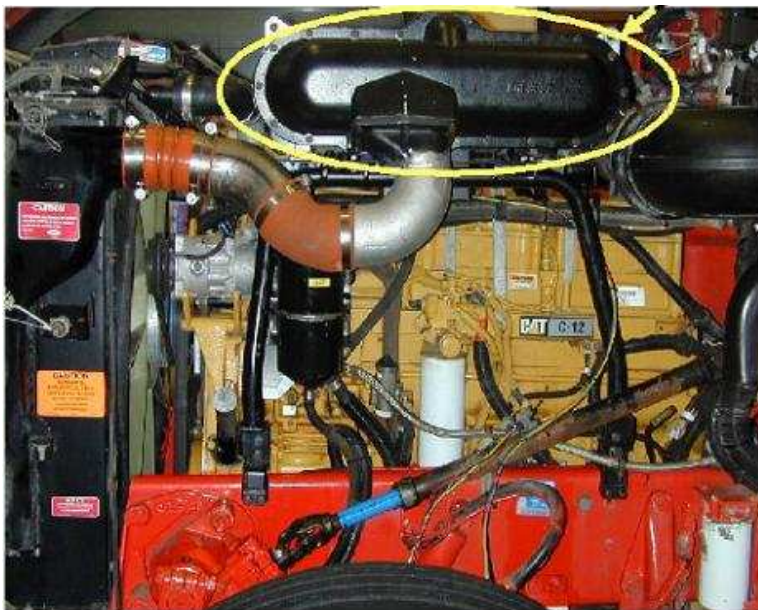
Σχήμα 2.4.14 . Εγκατάσταση μεμβράνης διαχωρισμού για εμπλουτισμό του αέρα εισαγωγής κινητήρα diesel φορτηγού οχήματος με άζωτο
