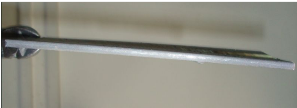
Εικόνα 4.8: «Πετσικάρισμα» (οριακά ορατό) των ελασμάτων λόγω απουσίας συγκράτησης, δηλαδή διαφοροποίησης της αρχικής γωνίας μεταξύ των ελασμάτων, η οποία μπορεί να γίνει αντιληπτή σαν «μη επιπεδότητα» μεταξύ των ελασμάτων.
