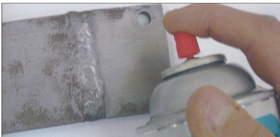
Εικόνες 4.12 & 4.13: Ο διαλύτης που χρησιμοποιείται ενάντια στις επικαλύψεις και η εφαρμογή του επάνω στο τεμάχιο
