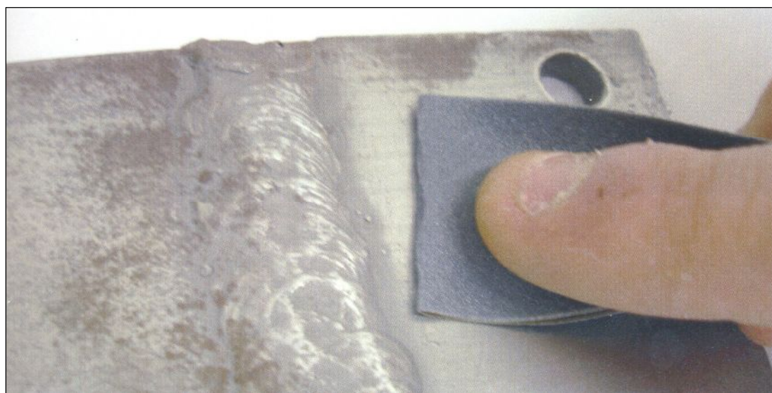
Εικόνες 4.14 & 4.15: Σμυριδόχαρτα κλιμακούμενης τραχύτητας για την λείανση της επιφάνειας και η εφαρμογή τους στο τεμάχιο
