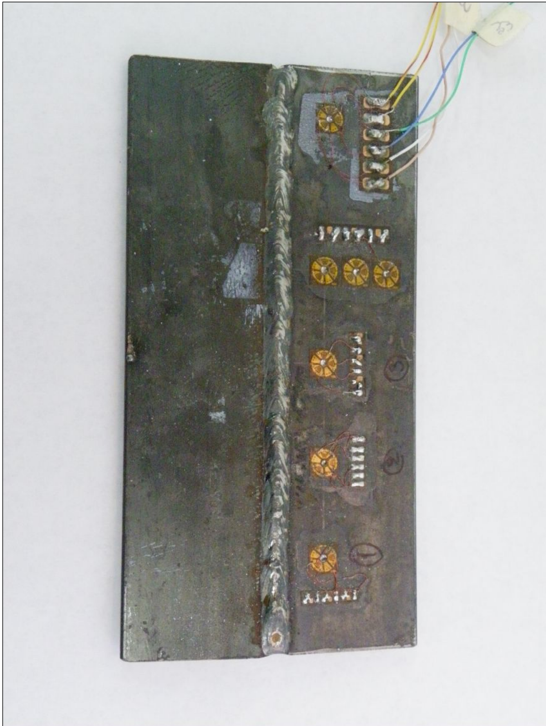
Εικόνα 4.43: Η τελική εικόνα του συγκολλημένου τεμαχίου με όλες τις ροζέτες κολλημένες σε αυτό (η φωτογραφία έχει ληφθεί μετά την διάτρηση)
