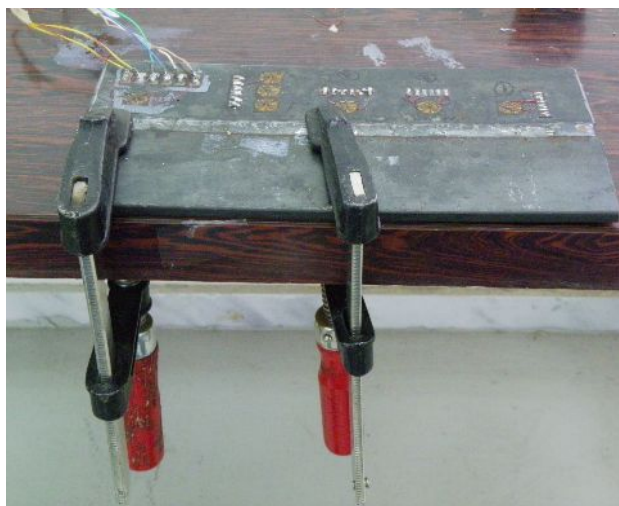
Εικόνα 4.44: Σταθεροποίηση των ελασμάτων με χρήση μέγγενης
