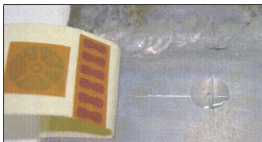
Εικόνα 4.30: Τοποθέτηση σταγόνας κόλλας στο κέντρο του σταυρού
