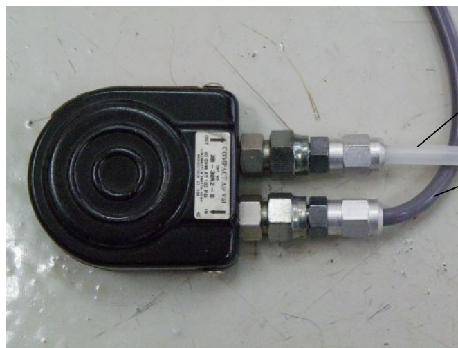
Εικόνα 4.48: Η βαλβίδα για την διοχέτευση του πεπιεσμένου αέρα στην διάταξη της διάτρησης
