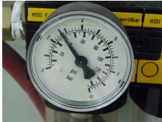
Εικόνα 4.47: Ρύθμιση του αέρα σε πίεση 40\text{psi}
