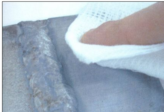
Εικόνες 4.17 έως και 4.21: Το ειδικό χημικό υγρό για την βελτίωση της επιφάνειας και η διαδικασία εφαρμογής του
