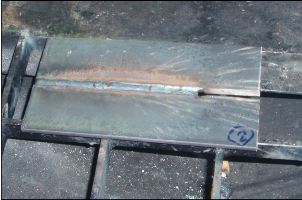
Εικόνα 4.5: Συγκόλληση τεμαχίων χωρίς να έχει προηγηθεί κάποιας μορφής συγκράτηση
