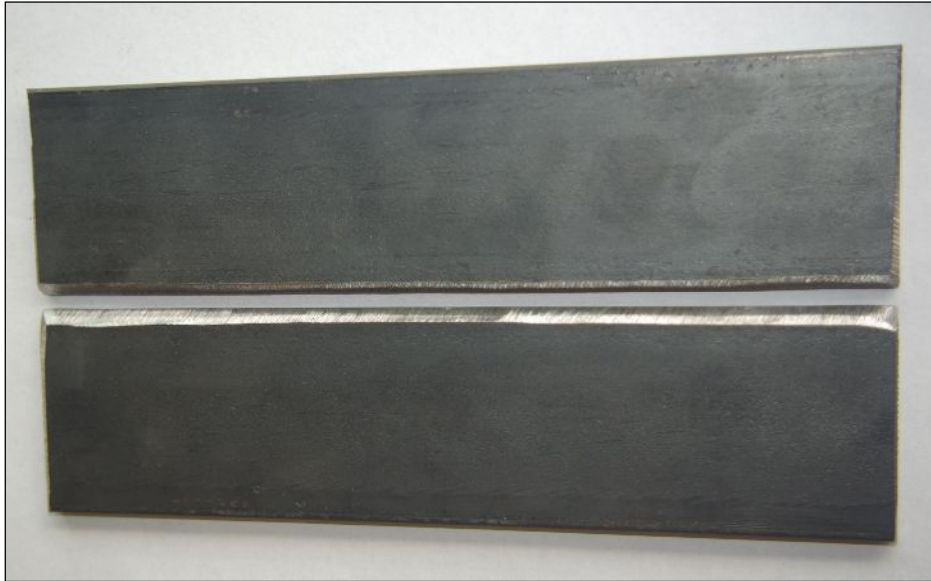
Εικόνες 4.2 & 4.3: Τελική μορφή των τεμαχίων πριν την πραγματοποίηση της συγκόλλησης
