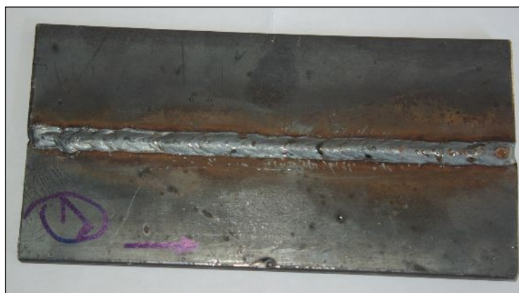
Εικόνα 4.10: Τα τεμάχια που επελέγησαν τελικά για την μέτρηση των παραμενουσών τάσεων
