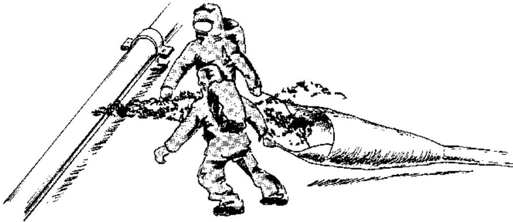
Σχήμα 5.6: Η χοάνη εφαρμόζεται στο σημείο διαρροής
