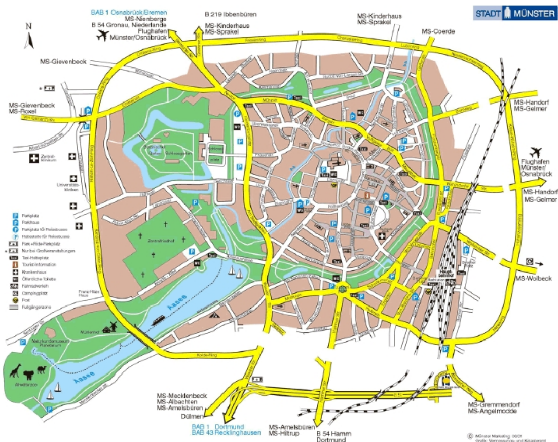
Σχέδιο 3.6: Το σύστημα μεταφορών στο Munster. Διακρίνονται οι δύο κύριοι οδικό δακτύλιοι, οι χώροι στάθμευσης (κατηγοριοποιημένοι σε κλειστούς, ανοικτούς, και αποκλειστικούς για τουριστικά λεωφορεία), η σιδηροδρομική γραμμή (Deutsche Bahn) και ο κεντρικός σταθμός στα ανατολικά και τέλος οι σταθμοί Park+Ride (νότια και δυτικά) σε σημαντικούς κόμβους του οδικού δικτύου.
