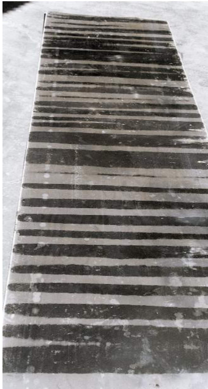
Σχήμα 4.2 Ελαττωματικό έλασμα από Chattering
