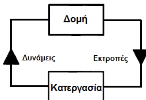
Σχήμα 4.4 Αναπαράσταση του chatter από έναν κλειστό βρόγχο
