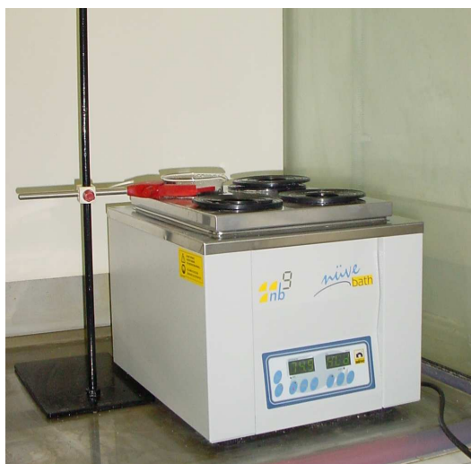
Εικόνα 5.3: Υδατόλουτρο του ΕΠΤ-ΕΜΠ με αποσταγμένο νερό
