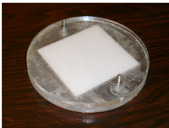
Εικόνα 3.5: Πρότυπη πηγή KCl (θήκη από Plexiglas)
