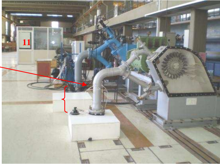
Εικόνα 3.6 Πρόοψη του μοντέλου και σημείο μέτρησης της πίεσης. Στο βάθος, αριστερά και πάνω φαίνεται η αίθουσα ελέγχου (11)
