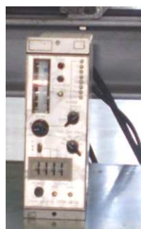
Εικόνα 5.19 Γέφυρα-ενισχυτής - "hardware signal conditioner" του μεταλλάκτη της ροπής
