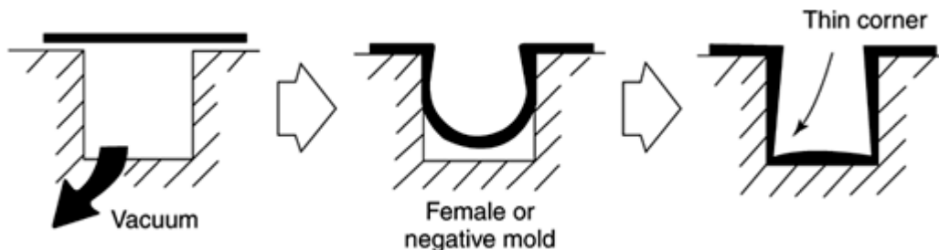
Σχήμα 3.4: Διαμόρφωση με θηλυκό ή αρνητικό καλούπι
