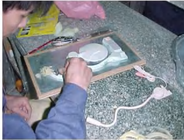
Σχήμα 4.12: Κατασκευή καλουπιού από πηλό
