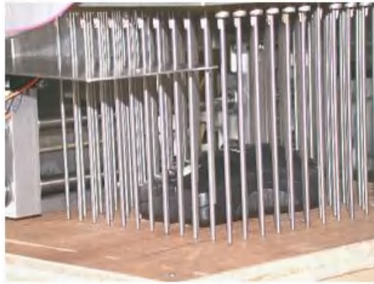
Σχήμα 4.24: Σύστημα ψηφιοποίησης με ακίδες
