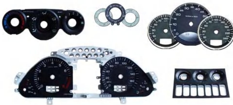
Σχήμα 7.14: Τυπικά προϊόντα παραγωγής θερμομόρφωσης με τη μέθοδο Niebling
