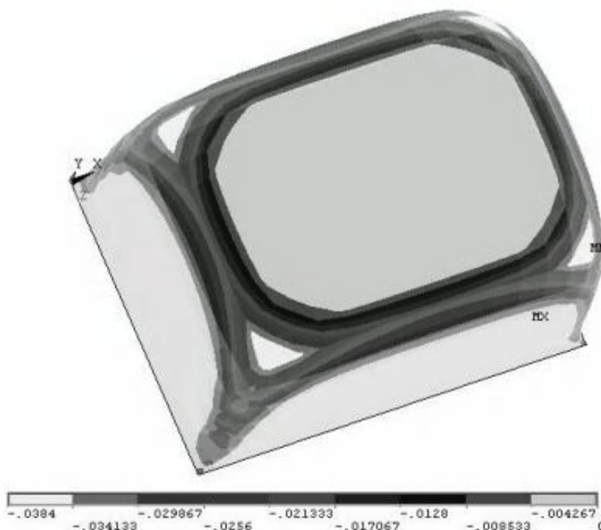
Σχήμα 7.8: Απόσταση μεταξύ μήτρας και σχηματιζόμενου φύλλου.
