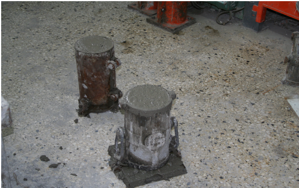
Σχήμα 4.17 Κυλινδρικά δοκίμια για έλεγχο αντοχής
