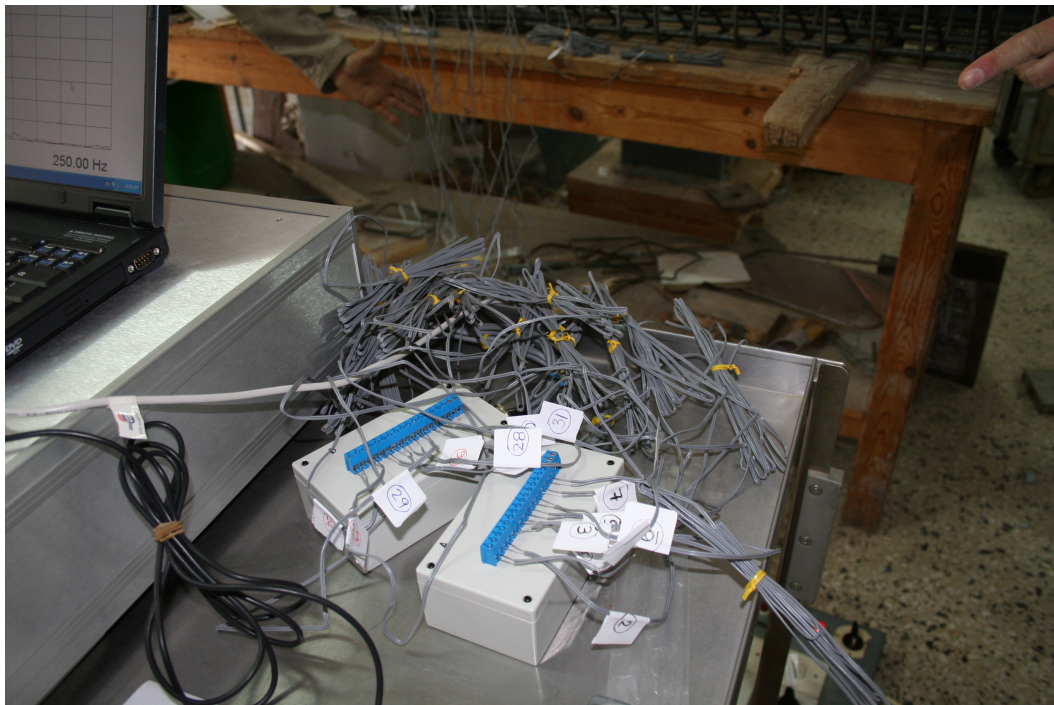
Σχήμα 4.22 Συνδεσμολογία μετρητών παραμόρφωσης με το σύστημα
