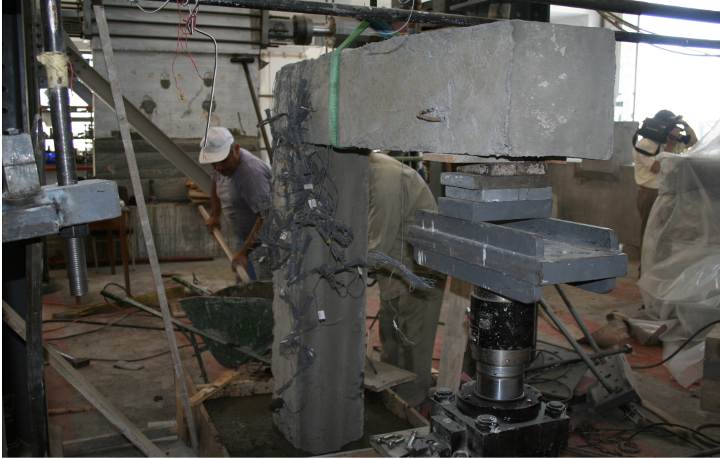
Σχήμα 4.16 Το δοκίμιο οπλισμένου σκυροδέματος στη βάση στήριξής του
