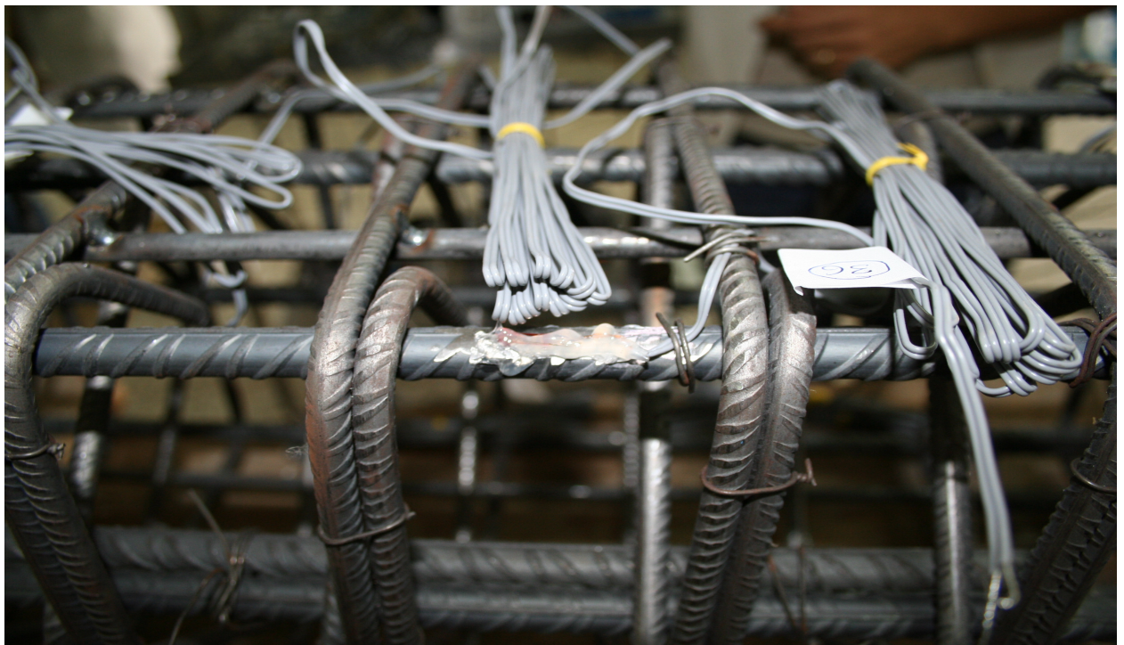
Σχήμα 4.7 Strain gage επί του διαμήκους οπλισμού
