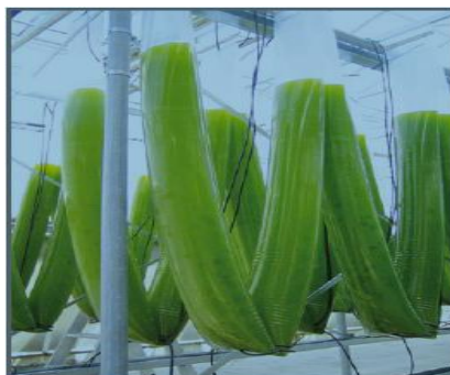
Σχ.6, Αντιδραστήρες σε σχήμα σακούλας, τοποθετημένοι σε σχήμα V 20 .
