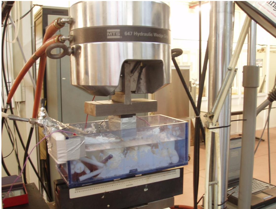
Κεφαλή της υδραυλικής μηχανής σε λειτουργία και το ηλεκτρολυτικό κελί από PVC
