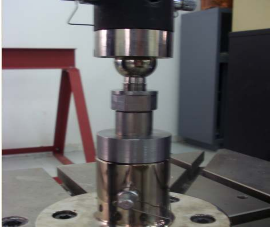
Σχήμα 6.3 β Φωτογραφία κατά την διάρκεια στατικού ελέγχου μεταλλικής κεφαλής με κωνική επιφάνεια σύμφωνα με το ISO 7206-10
