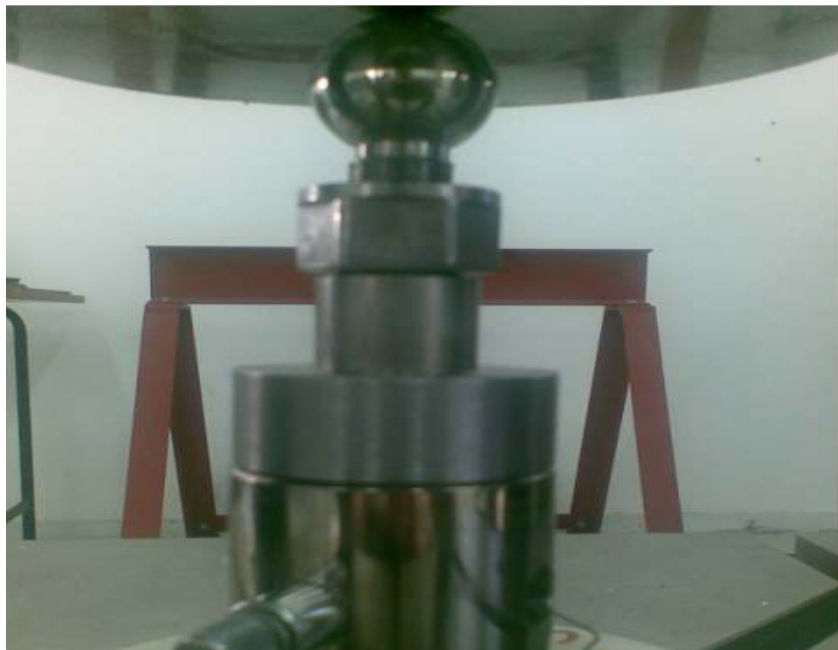
Σχήμα 6.3 α Φωτογραφία κατά την διάρκεια στατικού ελέγχου μεταλλικής κεφαλής με επίπεδη επιφάνεια σύμφωνα με το ISO 7206-10
