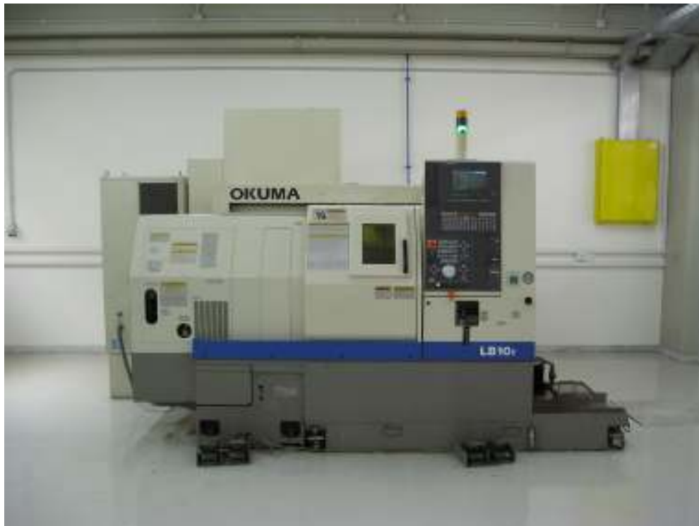
Σχήμα 2.4 Τόρνος CNC της εταιρείας OKUMA του τομέα Τεχνολογία των Κατεργασιών του ΕΜΠ.
