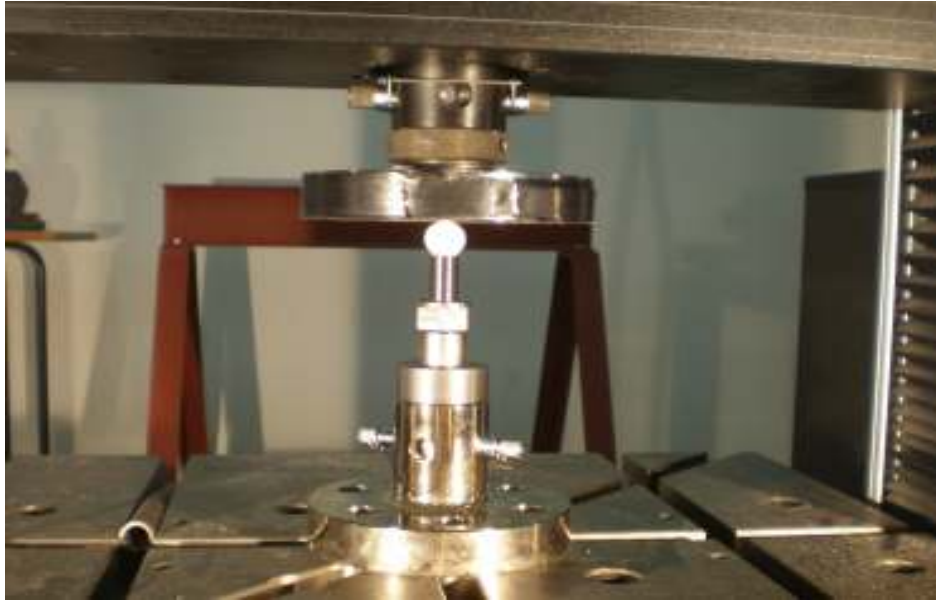
Σχήμα 6.2 β Φωτογραφία κατά την διάρκεια στατικού ελέγχου κεραμικής κεφαλής με επίπεδη επιφάνεια σύμφωνα με το ISO 7206-10
