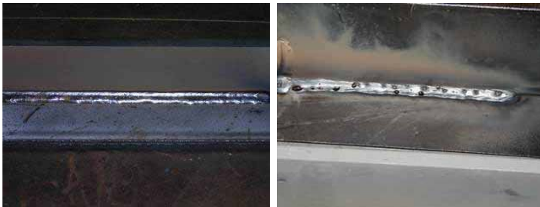
Εικόνα 3.4 – Σύγκριση ποιότητας συγκολλήσεων σε ανόργανο αστάρι (αριστερά) και εποξειδικό (δεξιά). Παρατηρούνται πόροι στη συγκόλληση δεξιά, λόγω των αερίων που εκλύθηκαν από το οργανικό αστάρι. [25]
