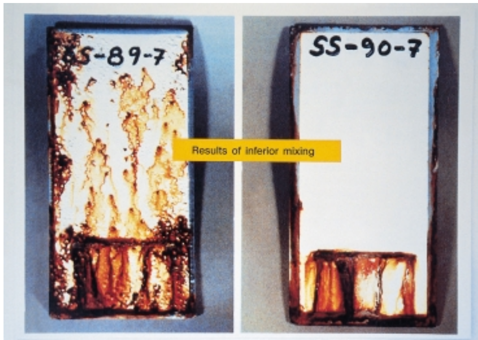
Εικόνα 3.5 – Αποτελέσματα ελλιπούς ανάμιξης συστατικών [26]
