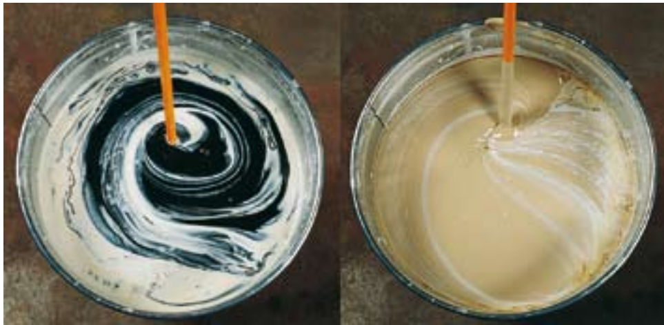
Εικόνα 3.6 – Η φάση ανάμιξης των συστατικών, μέχρι να αναμιχθούν πλήρως, εμφανίζουν διχρωμία [26]
