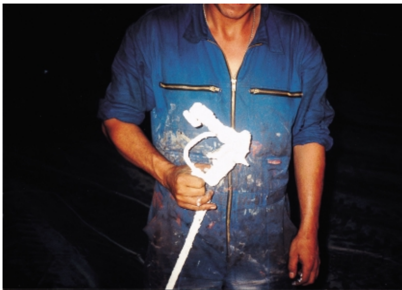
Εικόνα 4.13 - Το πιστόλι ψεκασμού σε κακή λειτουργική κατάσταση λόγω ελλιπούς καθαρισμού [26]
