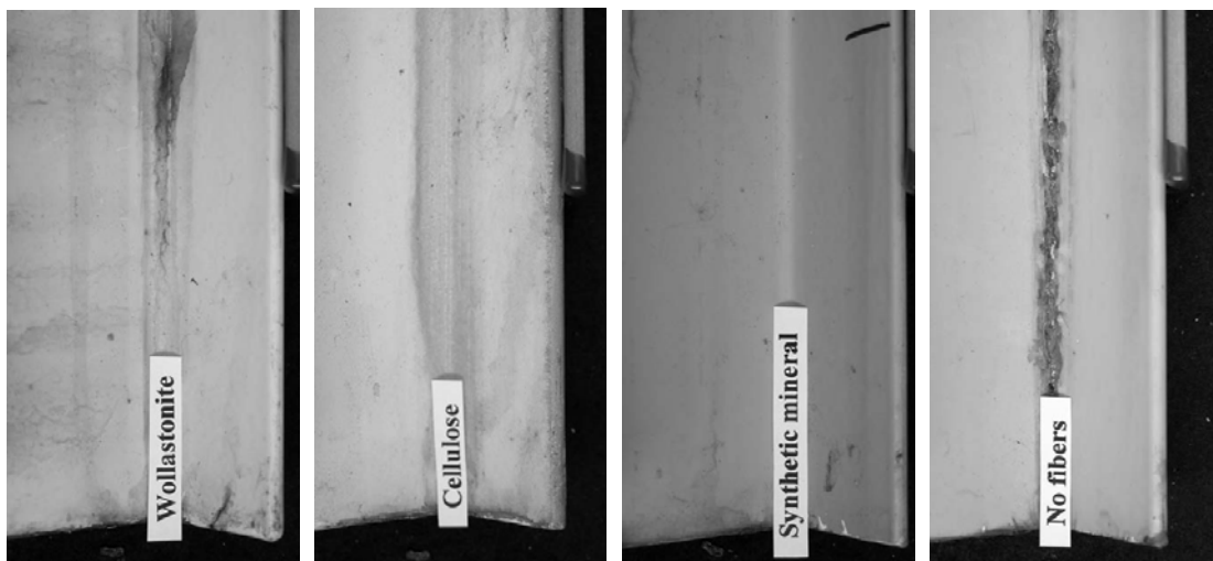
Εικόνα 3.10 – Εικόνες δοκιμίων μετά τη δοκιμή TM0304. Από αριστερά προς δεξιά: με ίνες πυριτικού νατρίου, με ίνες κυτταρίνης, με ορυκτές συνθετικές ίνες και τέλος το επικαλυπτικό χωρίς ενισχυτικές ίνες [44]
