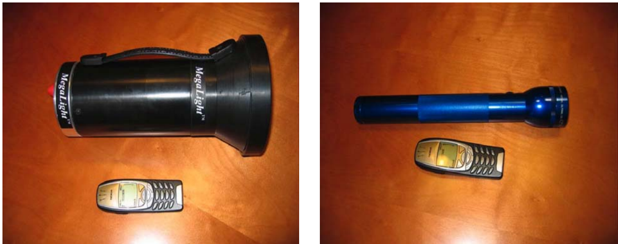
Εικόνα 3.20 - Ο φακός αριστερά είναι έντασης 35W, κατάλληλος για μεγάλες επιφάνειες, ενώ ο φακός δεξιά είναι κοινός 4D με λυχνία LED [42]
