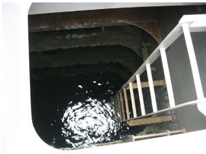
Εικόνα 4.15 - Η δυσκολία πρόσβασης στις δεξαμενές έρματος, όταν το πλοίο λειτουργεί, είναι προφανής
