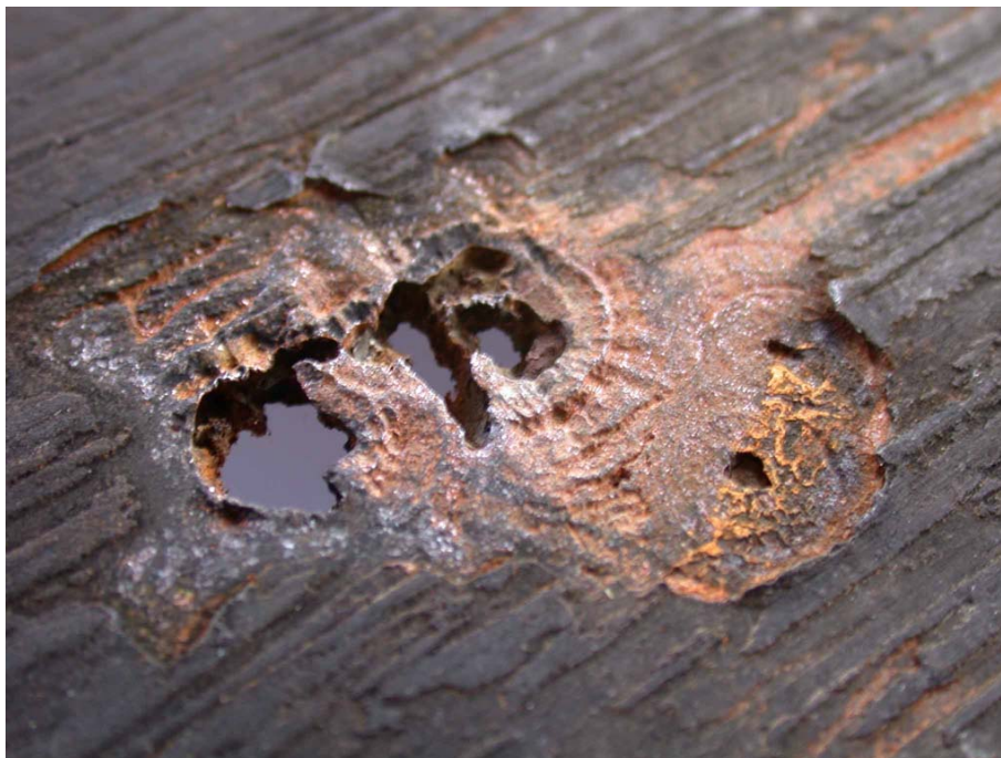
Εικόνα 2.8 - Μορφολογία βακτηριακής διάβρωσης
