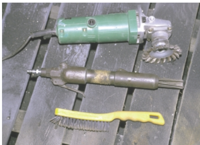
Εικόνα 4.8 - Συνήθης εξοπλισμός μηχανικού και χειρονακτικού καθαρισμού (πρότυπο St κατά ISO) [26]
