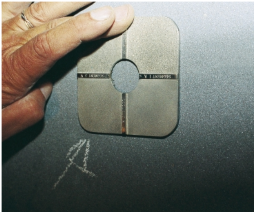
Εικόνα 4.3 - Έλεγχος καθαρότητας μεταλλικής επιφάνειας από 4 πρότυπες κατηγορίες [26]
