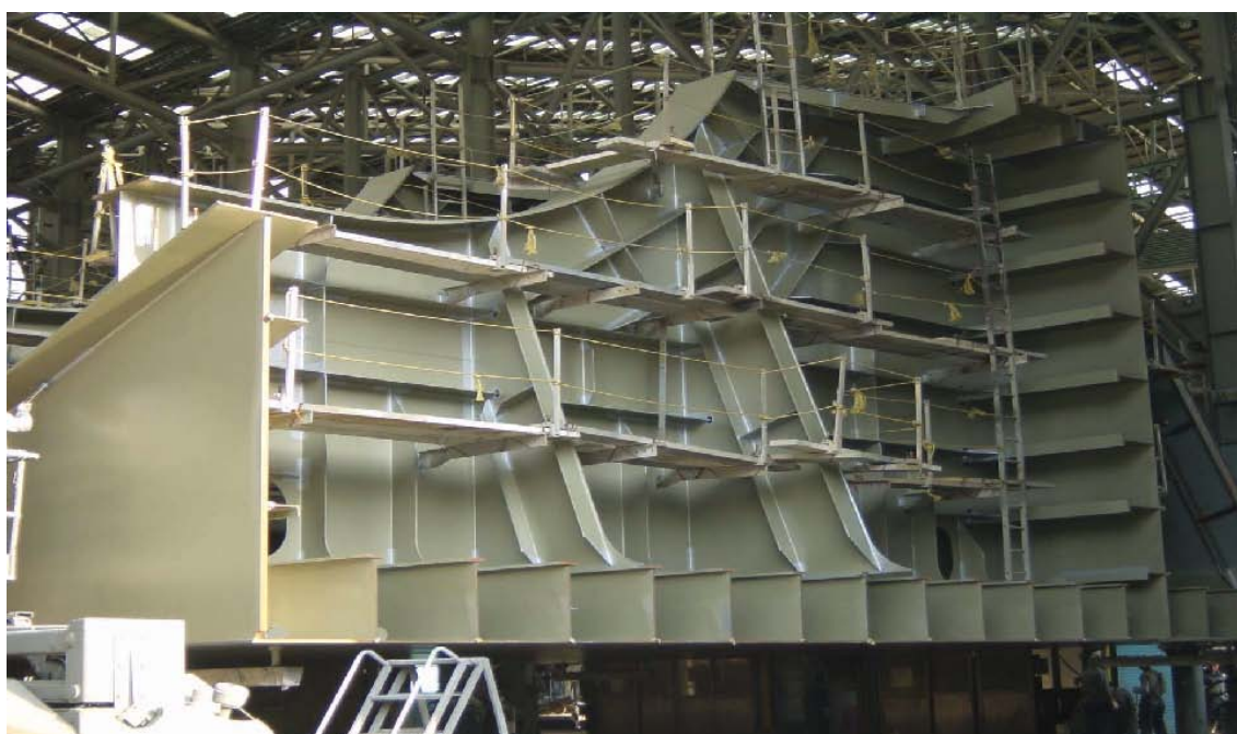
Εικόνα 7.5 - Φωτογραφία βαμμένου τμήματος πλοίου υπό ανέγερση, στο σχετικό υπόστεγο επικαλύψεων [26]
