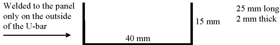
Εικόνα 7.6 - Σχηματική αναπαράσταση του συγκολλημένου ελάσματος μορφής U, στις πλάκες 3 και 4 [59]
