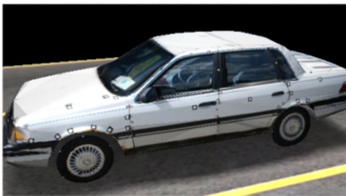
Εικόνα 2.5: Υποδειγματικό όχημα από επεξεργασμένες φωτογραφίες.
