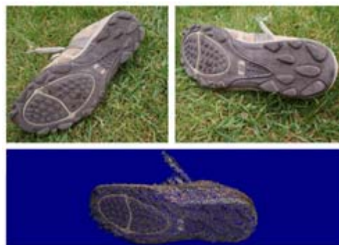
Εικόνα 2.10: Σάρωση του παπουτσιού, ώστε να προσαρμοστεί στο τρισδιάστατο σχέδιο-μοντέλο του πέλματος.
