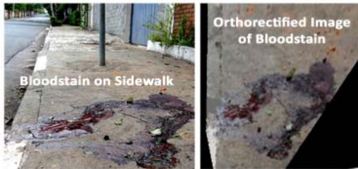
Εικόνα 2.1: Οι κηλίδες αίματος μπορούν να αναχθούν σε ορθή προβολή για να αφαιρεθεί η παραμόρφωση της προοπτικής και να δοθούν οι τελικές, σωστές μετρήσεις.
