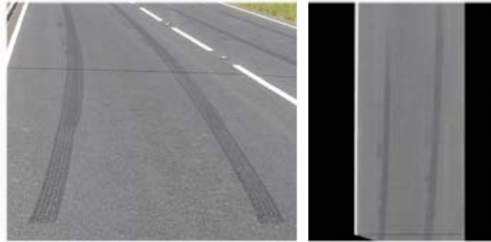
Εικόνα 2.12: Ορθοαναγμένη εικόνα ιχνών πέδησης για άμεσες μετρήσεις.
