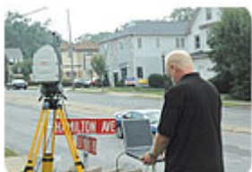
Εικόνα 3.3: Η τεχνολογία σάρωσης λέιζερ επιτρέπει στο χρήστη να παρακολουθεί τα στοιχεία-δεδομένα, όσο αυτά συλλέγονται.
