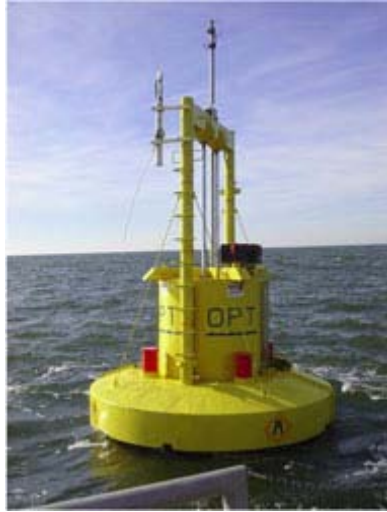
Εικόνα 1.9 Σημειακός απορροφητήρας κυματικής ενέργειας εγκατεστημένος στην ανοιχτή θάλασσα
