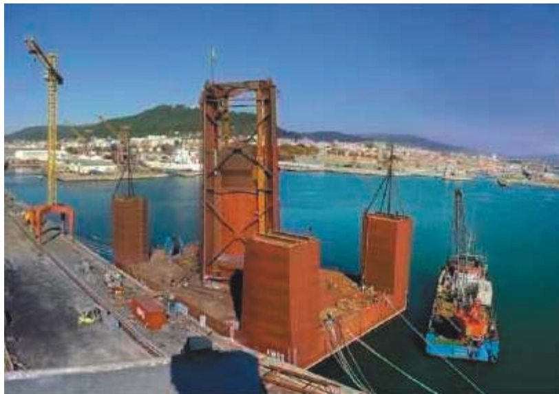
Εικόνα 1.10 Υποβρύχια συσκευή διαφορικής υδροστατικής πίεσης
