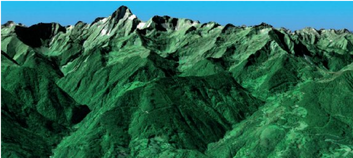
Εικόνα 1.28 Τρισδιάστατη απεικόνιση του όρους Βαλιέρ (Γαλλία) από εικόνα 2.5m και DEM Spot
