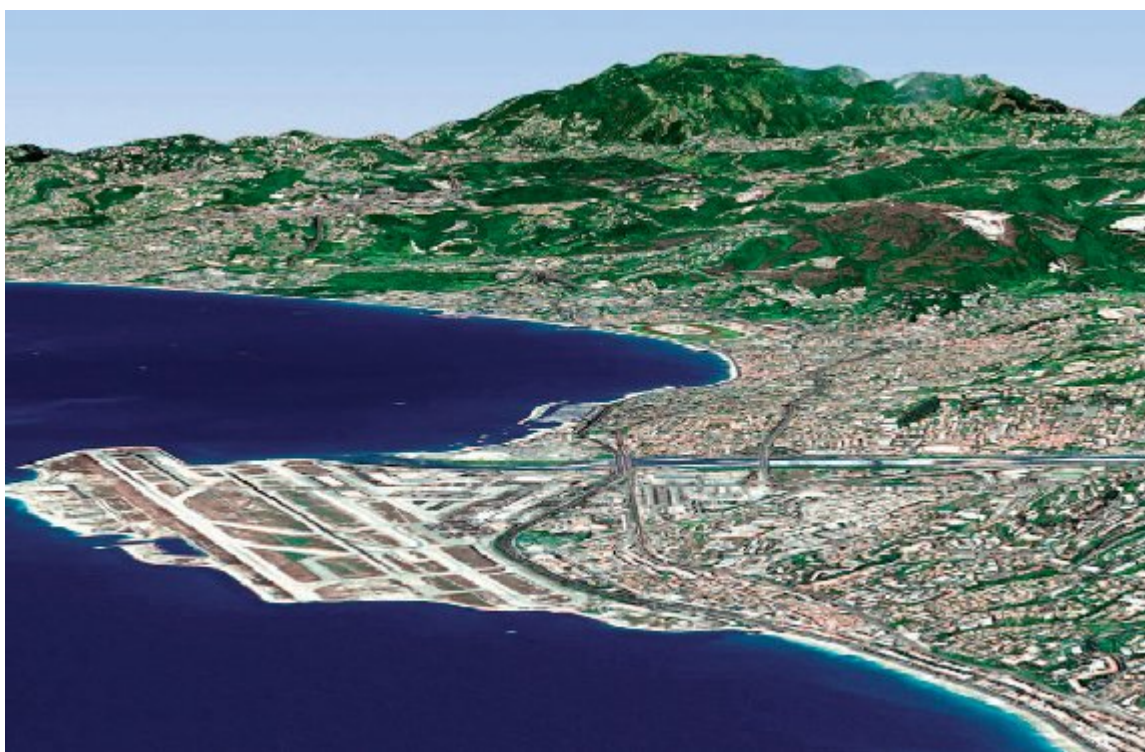
Εικόνα 1.27 Τρισδιάστατη απεικόνιση του αεροδρομίου Νις (Γαλλία) από εικόνα 2.5m και DEM Spot
