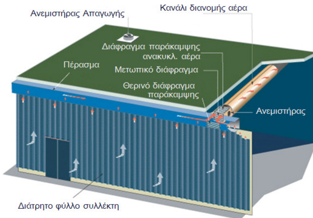
Σχήμα 3.20 Ηλιακός ξηραντήρας δωματίου Solarwall® [72]
