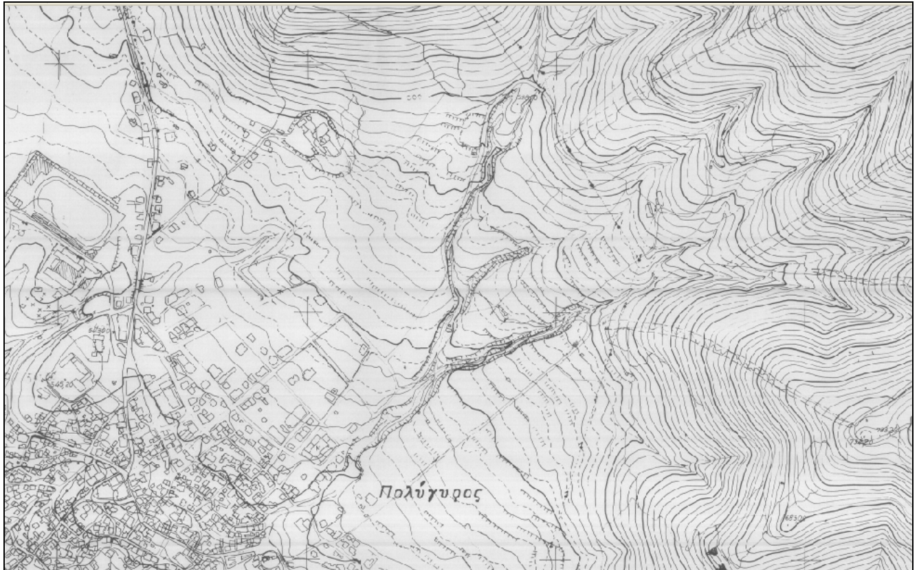
Εικόνα 5.15: Τμήμα τοπογραφικού διαγράμματος κλίμακας 1:5.000 που χρησιμοποιήθηκε. Μεταξύ των στοιχείων που έχουν αποτυπωθεί σε αυτό, διακρίνονται δρόμοι και κτίσματα του οικισμού «Πολύγυρος», πρανή, ισούψεις καμπύλες, όπως επίσης και κάποια ρέματα.
