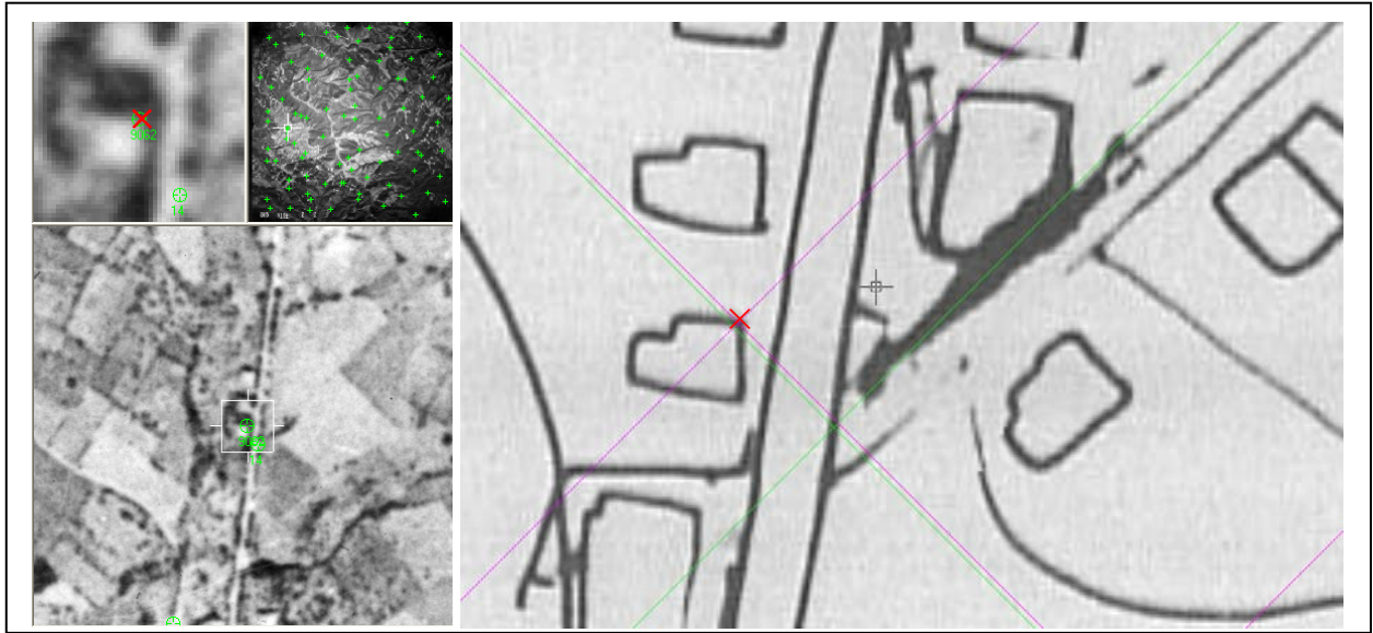
Εικόνα 34: Το σημείο 9062 (γωνία κτίσματος) στις αεροφωτογραφίες του 1945 και στο χάρτη.
