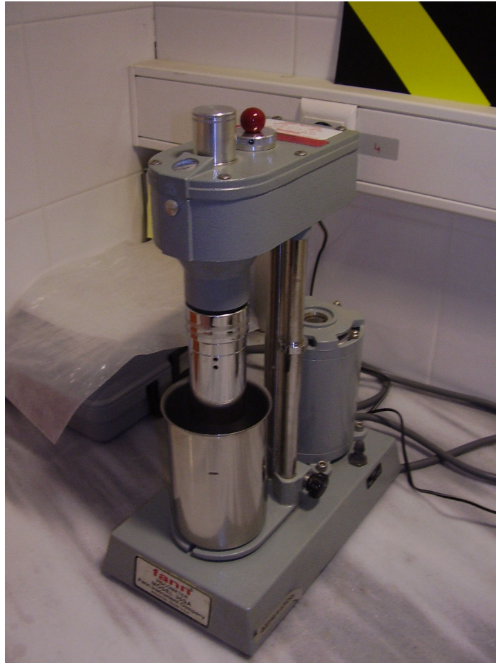
Εικόνα 15: Χρησιμοποιηθέν ιξωδόμετρο του οίκου fann.
