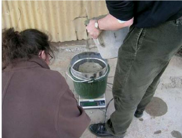
Εικόνα 14: Δοκιμή σταθερότητας με κοσκίνιση.
