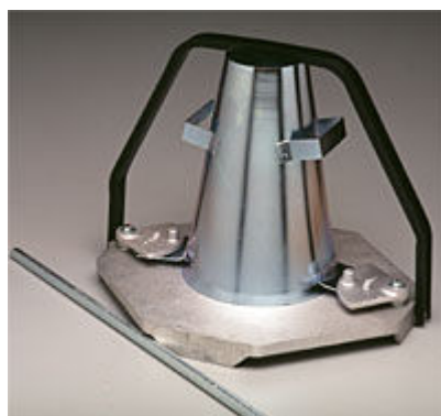
Εικόνα 10: Εξοπλισμός για τη δοκιμή εξάπλωσης.
