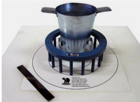
Εικόνα 11: Εξοπλισμός δοκιμής J-Ring.
