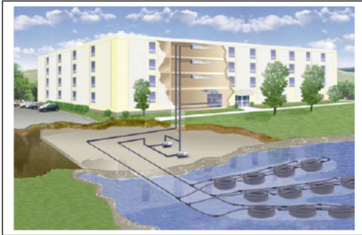
Σχήμα 3.15 Σύστημα βρόγχου νερού επιφανείας
