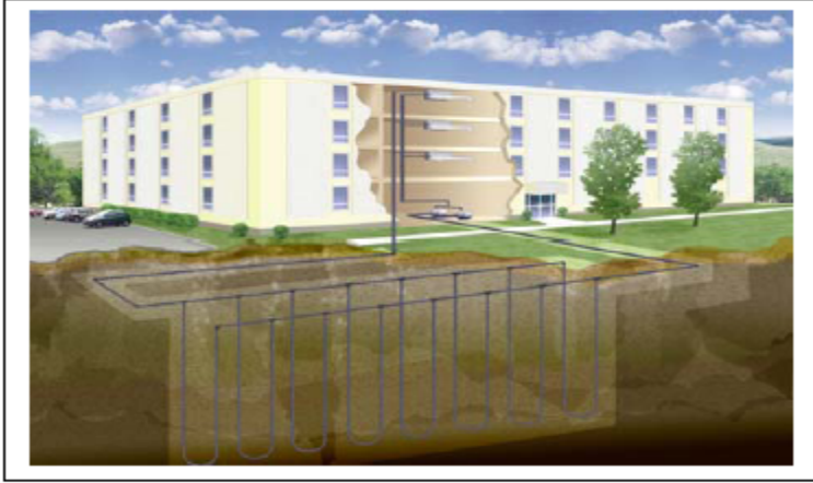
Σχήμα 3.12 Σύστημα κατακόρυφου βρόγχου
