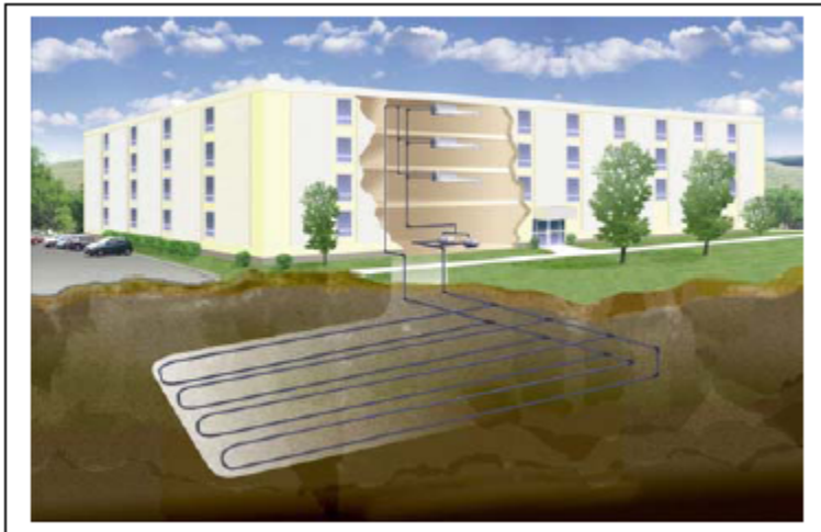
Σχήμα3.11 Σύστημα κλειστού οριζόντιου βρόγχου
