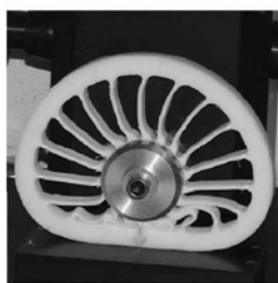
Σχήμα 2.5 Πρωτότυπα των τροχών του PackBot (πάνω) και αποτέλεσμα των ελέγχων αντοχής (κάτω).
