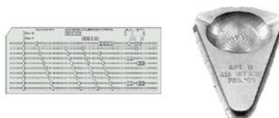
Σχήμα 3.5 Διάτρητη κάρτα και τασάκι κατασκευασμένο από την πρώτη ψηφιακά καθοδηγούμενη εργαλειομηχανή με τη βοήθεια της APT
