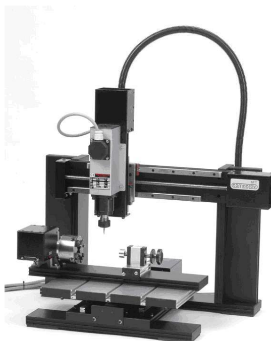
Σχήμα 5.2 Η επιτραπέζια φρέζα CNC Comagrav Mt Profi
