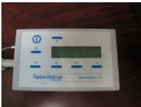
Σχήμα 5.42 Το τραχύμετρο Taylor Hobson Surtronic 3+
