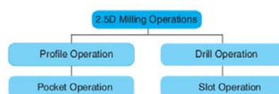
Σχήμα 3.25 Υποδιαιρέσεις 2.5D φρεζαρίσματος
