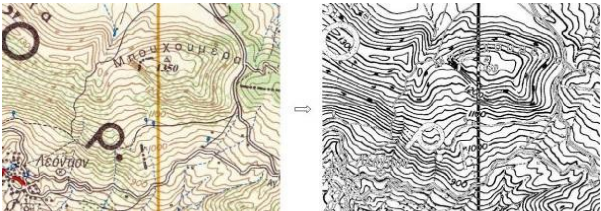
Σχήμα Β7: Προετοιμασία ψηφιακού ( ψηφιδωτού ) χάρτη για ημιαυτόματη διανυσματοποίηση με το λογισμικό ArcGIS
