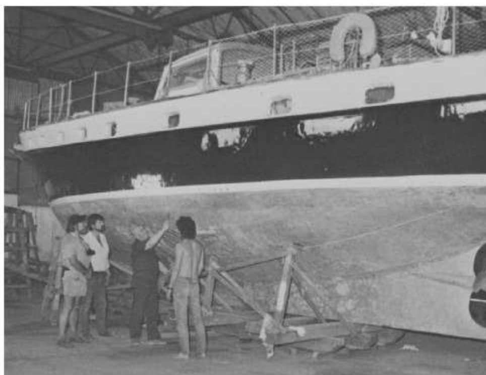
Φωτογραφία9.12-Η γάστρα του "Asperida" βαμμένη πάνω από την ίσαλο γραμμή και άβαφτη κάτω από την ίσαλο γραμμή
