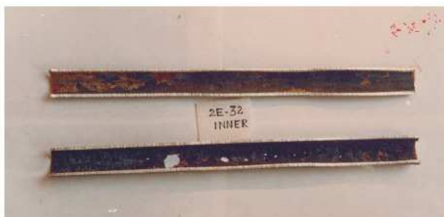
Φωτογραφία 8.9-εσωτερική επιφάνεια του σωλήνα της μονάδας 1
