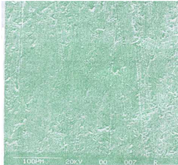
Εικόνα2.24-μικρογραφία του κράματος με 0.5% Fe που δείχνει διάβρωση με βελονισμούς
