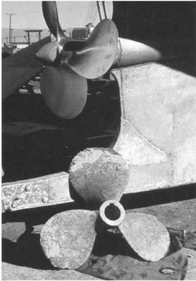
Φωτογραφία 9.13-κάτω φαίνεται η προπέλα που αστόχησε και ήταν από κατασκευασμένη από ορείχαλκο μαγγανίου
