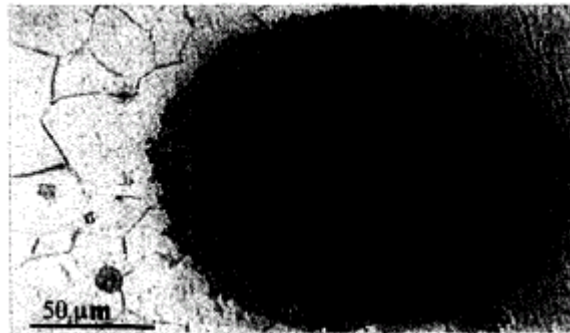
Φωτογραφία 7.18-επιφάνεια του C70600 μετά από 69 ώρες λειτουργίας της συσκευής και την παροχή διοξειδίου του άνθρακα στο σύστημα
