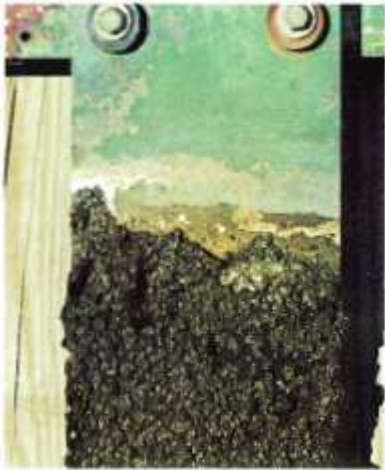
Φωτογραφία 5.19-βιομόλυνση του 90-10 στην ίσαλο γραμμή για χρόνο έκθεσης τους 4 μήνες
