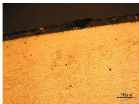
Φωτογραφία8.3-μικροδομή μέρους της επιφάνειας του σωλήνα όπου δεν υπήρχαν βελονισμοί
