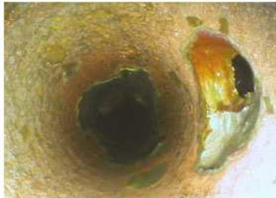
Φωτογραφία 8.14-βελονισμοί στην εσωτερική επιφάνεια σωλήνα από C70600
