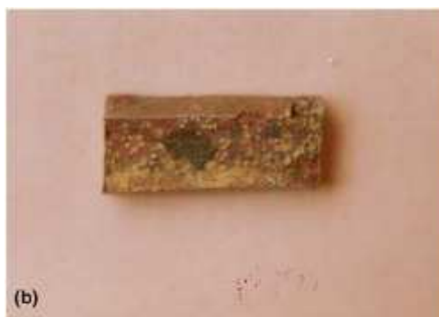
(b) Φωτογραφία 8.11-επικαθίσεις της εσωτερικής επιφάνειας του σωλήνα της μονάδας 1
