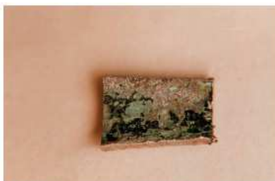
Φωτογραφία 8.12-επικαθίσεις της εσωτερικής επιφάνειας του σωλήνα της μονάδας 2
