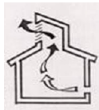
Εικόνα 64 Ηλιακή καμινάδα, σχηματική διάταξη και παρουσίαση του τρόπου λειτουργίας
