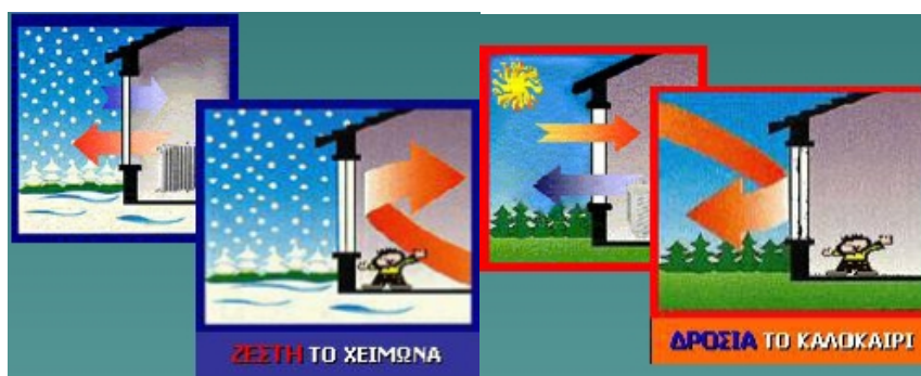
Εικόνα 41 Απεικόνιση συμπεριφοράς απλών και διπλών τζαμιών
