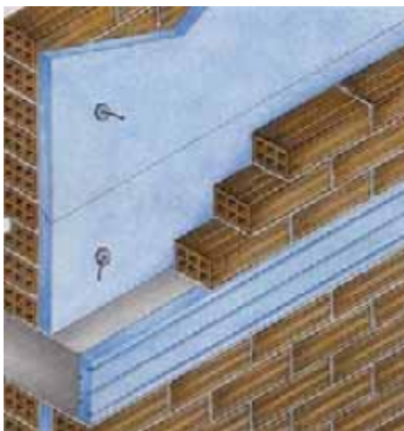
Εικόνα 30 Σχηματική παρουσίαση μόνωσης στον πυρήνα κατακόρυφου στοιχείου
