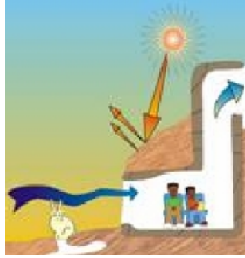
Εικόνα 75 Αναπαράσταση συστήματος άμεσου και έμμεσου δροσισμού από το έδαφος
