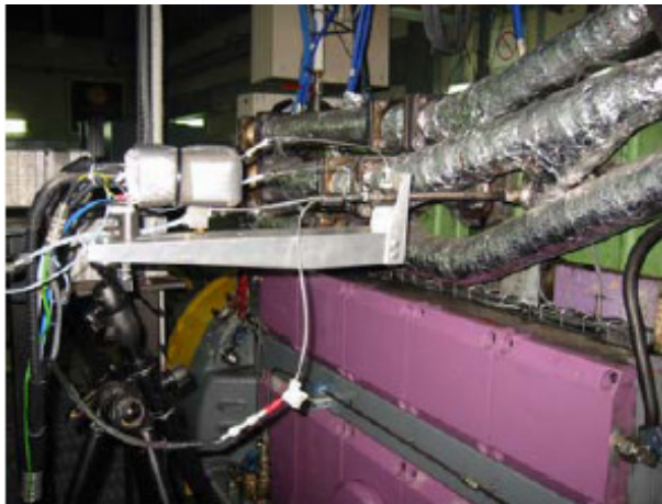
Σχήμα 5.1– Θέση δειγματολήπτη στο σύστημα εξαγωγής του κινητήρα του εργαστηρίου
