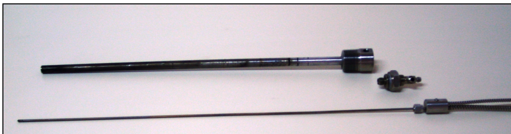
Σχήμα 6.1β – Δειγματολήπτης με την επέκταση 3 (εξάρμωση – άρμωση)
