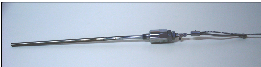
Σχήμα 6.1β – Δειγματολήπτης με την επέκταση 3 (εξάρμωση – άρμωση)
