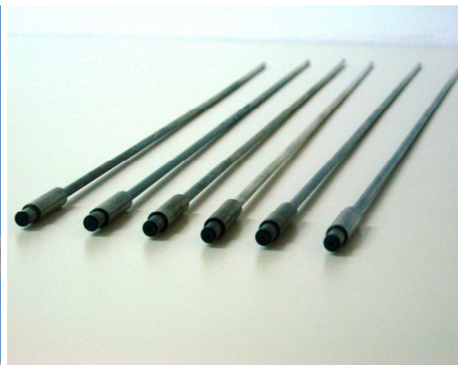
Σχήμα 3.2β – Οι 6 επεκτάσεις, εσωτερικών διαμέτρων 0.3, 0.5, 0.66, 0.8, 1.0 και 1.2 mm
