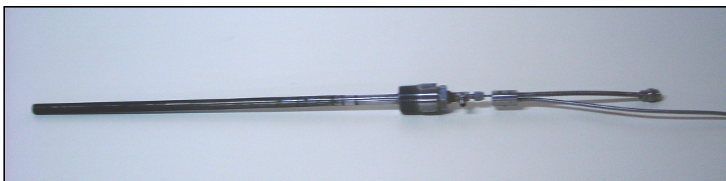
Σχήμα 6.1γ – Ενιαίος εκτεταμένος δειγματολήπτης (εξάρμωση – άρμωση)
