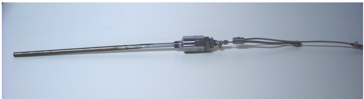
Σχήμα 3.10 – Ο δειγματολήτης σε κατάσταση εξάρμωσης και άρμωσης
