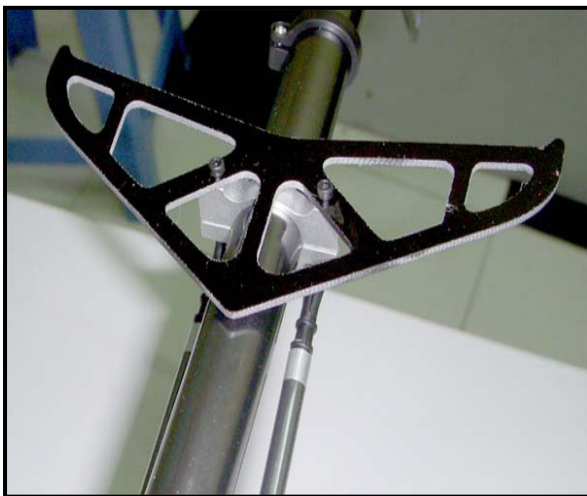
Εικόνα 2-7 : Οριζόντιο Σταθεροποιητικό Πτερύγιο
