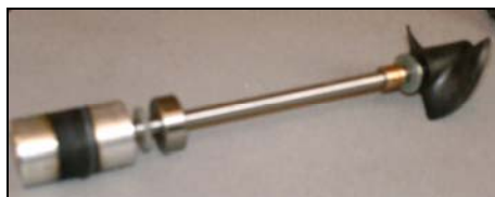
Εικόνα 1.1) Φωτογραφίες του άξονα της προπέλας των εδράνων κύλισης του ελαστικού συνδέσμου και της πίσω όψης του προωθητήρα με ενσωματωμένη την προπέλα. Φαίνεται η βάση στήριξης του ηλεκτρικού κινητήρα.
