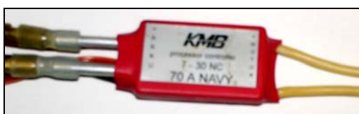
Εικόνα 1.2) Ο παλμοτροφοδοτικός μετατροπέας του ηλεκτρικού κινητήρα
