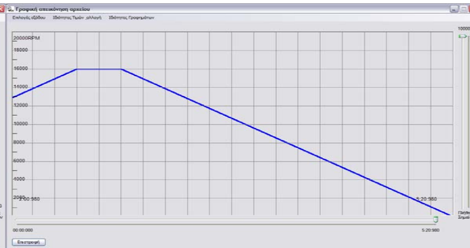
Σχ 7.3) Αύξηση της δράσης ελέγχου από 0 ~ 16000 του αρχείου αποστολής. Σχ 7.4) Αύξηση της δράσης ελέγχου από 16000 ~ 0 του αρχείου αποστολής.
