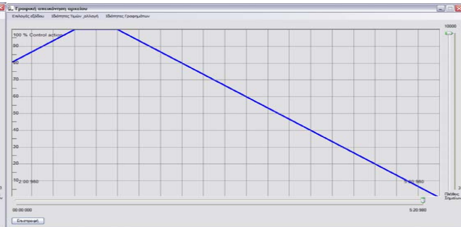
Σχ 7.1) Αύξηση της δράσης ελέγχου από 0 ~ 100% του αρχείου αποστολής. Σχ 7.2) Μείωση της δράσης ελέγχου από 100% ~ 0 του αρχείου αποστολής.
