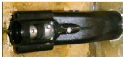
Εικόνα 1.1) Φωτογραφίες του άξονα της προπέλας των εδράνων κύλισης του ελαστικού συνδέσμου και της πίσω όψης του προωθητήρα με ενσωματωμένη την προπέλα. Φαίνεται η βάση στήριξης του ηλεκτρικού κινητήρα.
