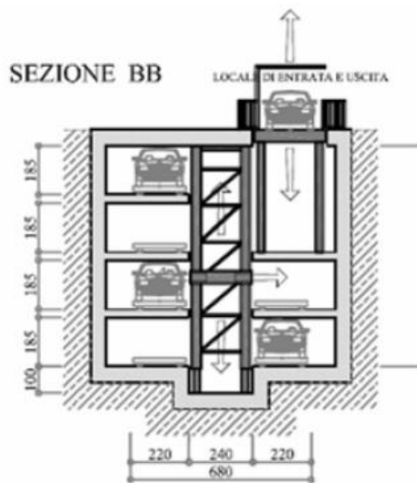
Σχήμα 7.3. Υπόγειος αυτόματος σταθμός με ανελκυστήρα ιταλικής εταιρείας.
